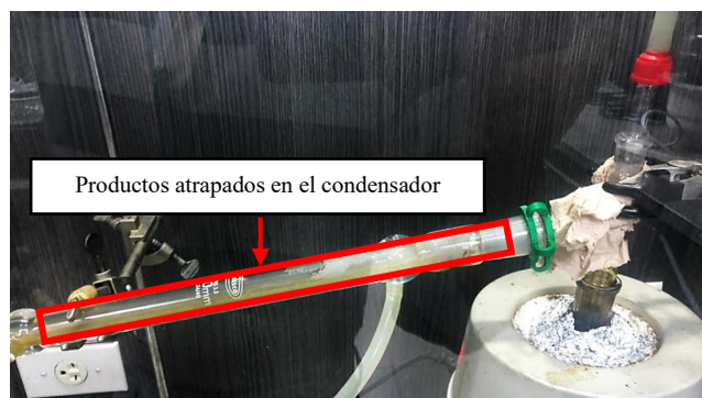
Figura 8. Productos de la reacción atrapados en el condensador
