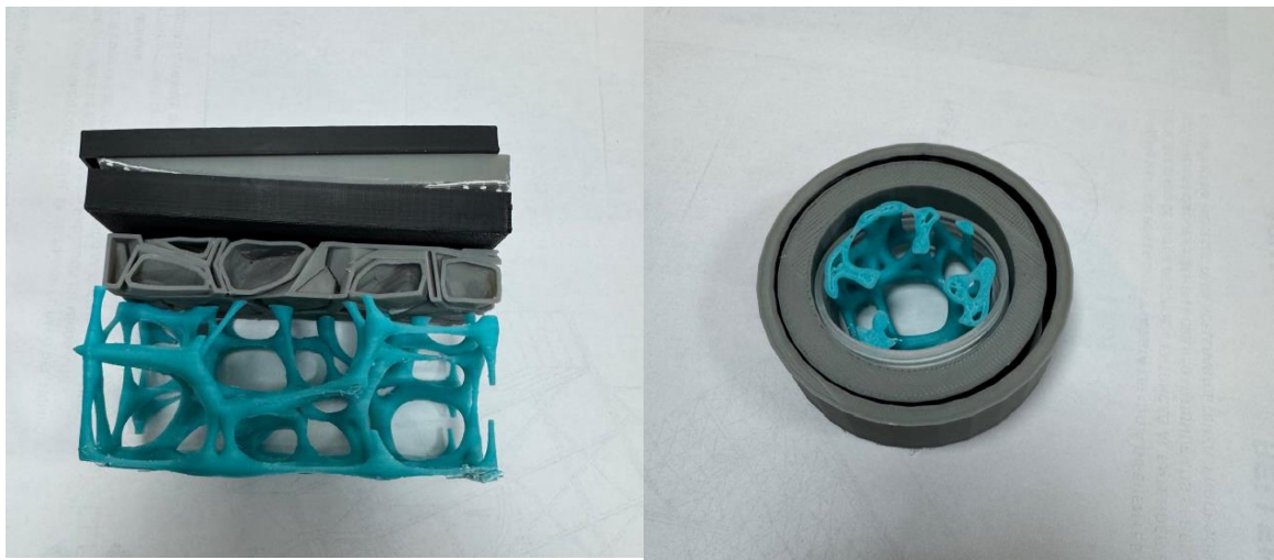
Figura 51. Impresión 3D: Detalle de estructura/capas de muros y columnas [Fotografía]. Elaboración: María José Cárdenas, y Pamela Chamorro (2025).
