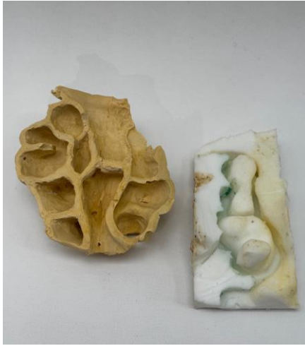
Figura 36. Prototipo de maqueta en yeso con su molde en silicona. [Fotografía]. Elaboración: María José Cárdenas, y Pamela Chamorro (2025).
