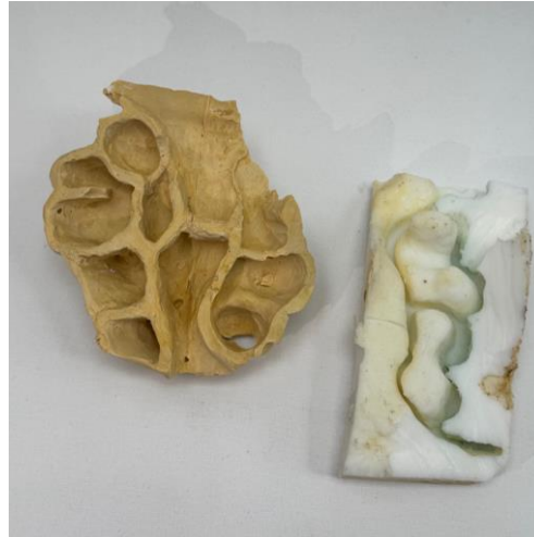
Figura 36. Prototipo de maqueta en yeso con su molde en silicona. [Fotografía]. Elaboración: María José Cárdenas, y Pamela Chamorro (2025).
