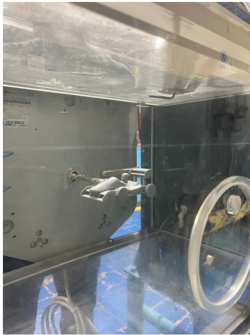
Figura 11.9: Prueba túnel de viento del carro impreso a escala.
