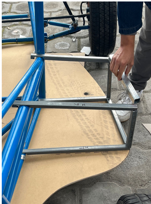
Figura 8.6: Construcción de estructura para soporte de pontones.
