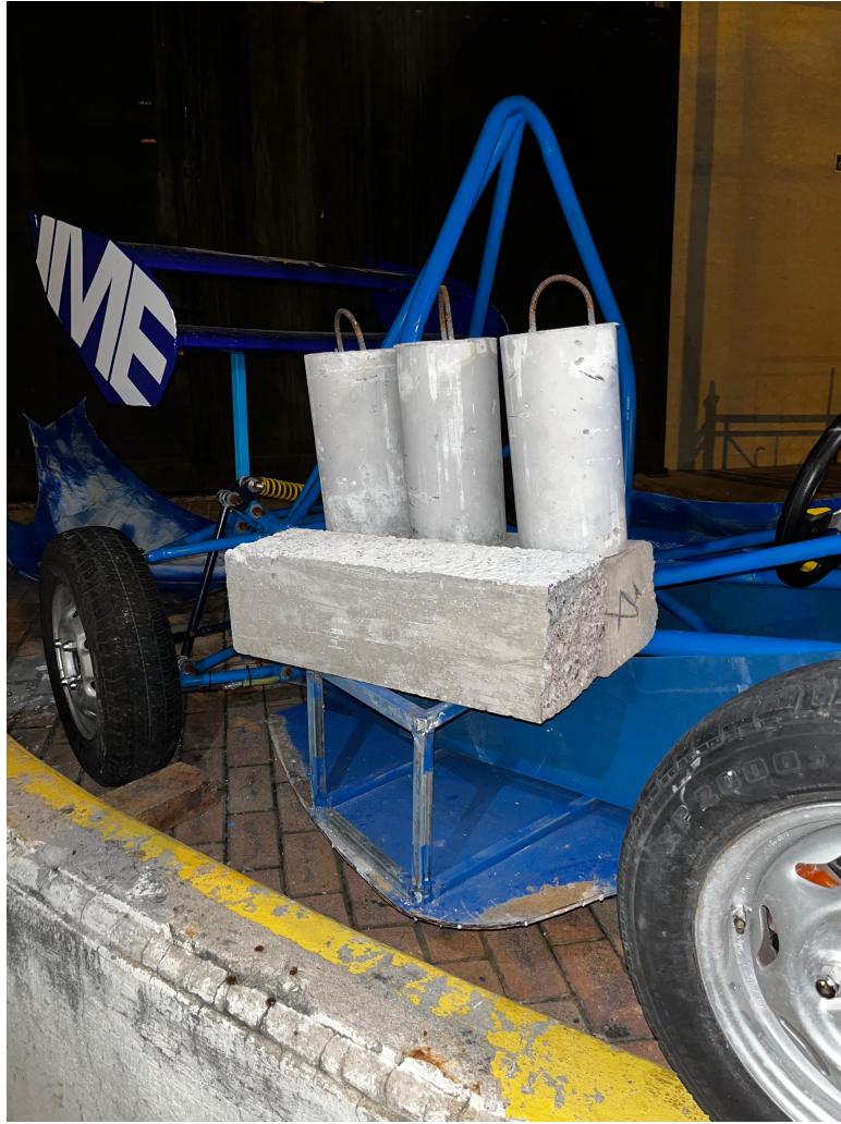
Figura 11.4: Prueba de carga sobre los pontones con el peso de dos personas
