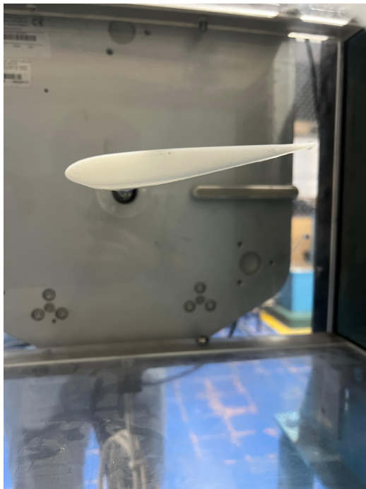
Figura 11.6: Prueba túnel de viento del ala a 8.5^\circ .
