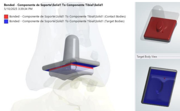
Figura 37. Condición de contacto “BONDED” entre el componente tibial y el hueso de la tibia
