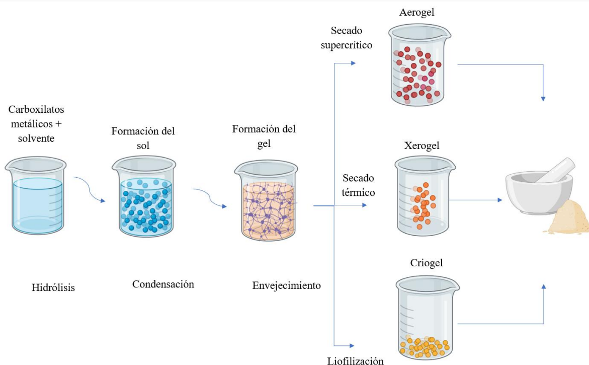
Figura 18. Esquema de las etapas que tienen lugar en el proceso de síntesis por método de sol-gel
