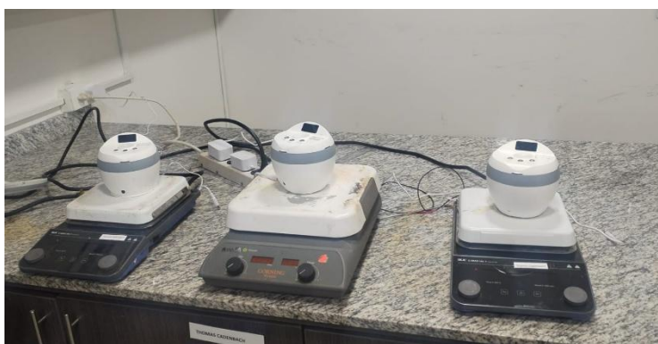
Figura 31. Montaje experimental para los ensayos de piezocatálisis en ausencia de luz
