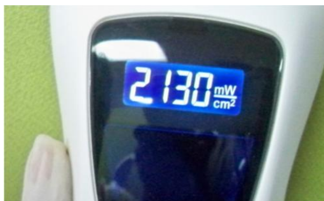
Figura 11. Medición con radiómetro lámpara VALO.
