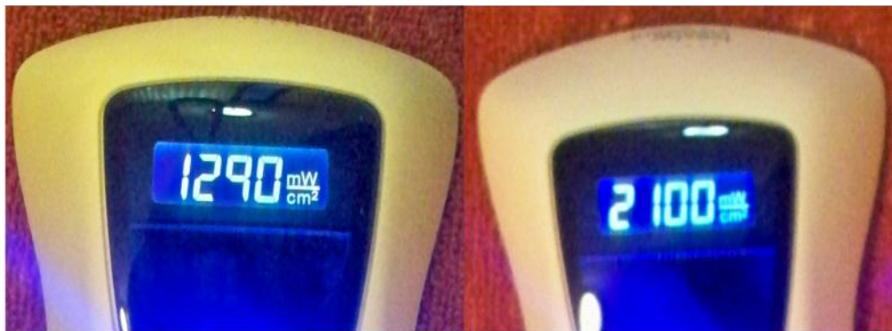
Figura 10. Medición con radiómetro lámpara BLUEPHASE.
