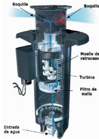
**Figura 2.5.** Aspersor de turbina.
