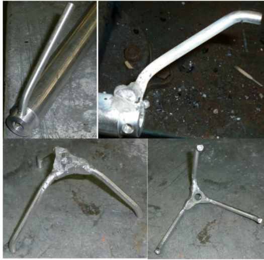
Figura 3- 3: Patas fijas y Anillo de Sujeción (Hecho en Aluminio 6061)
