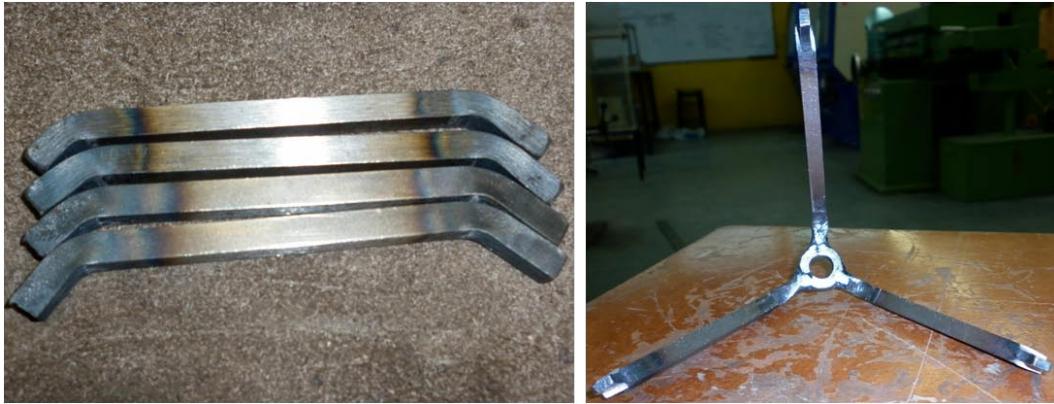
Figura 3- 4: Patas fijas y Anillo de Sujeción (Hecho en Acero A36).
