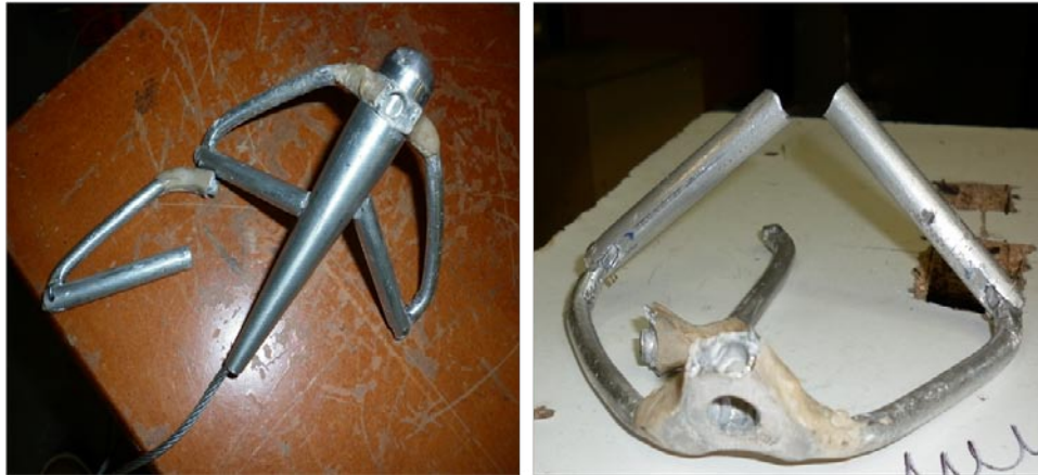
Figura D- 4: Daño 2 GPF (Rotura en el punto de soldadura)
