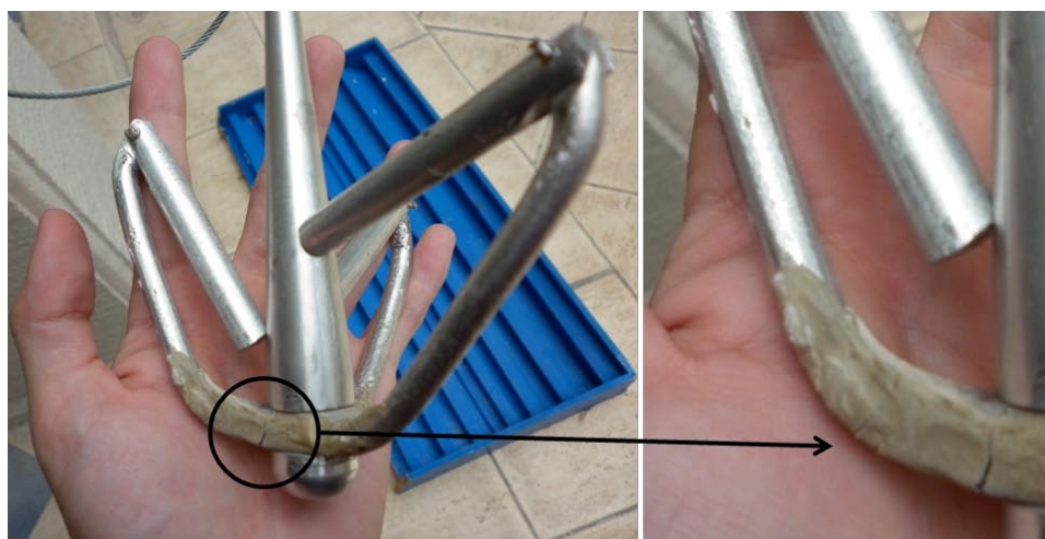
Figura D- 3: Daño GPF (Falla en el punto de Soldadura).
