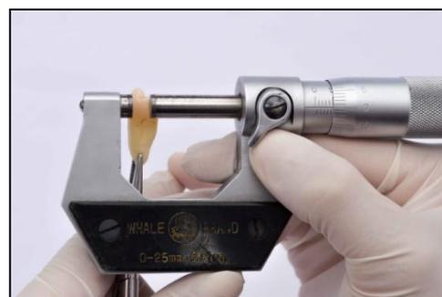
**Figura N. 3.** Coronas dentales medidas con micrómetro.
