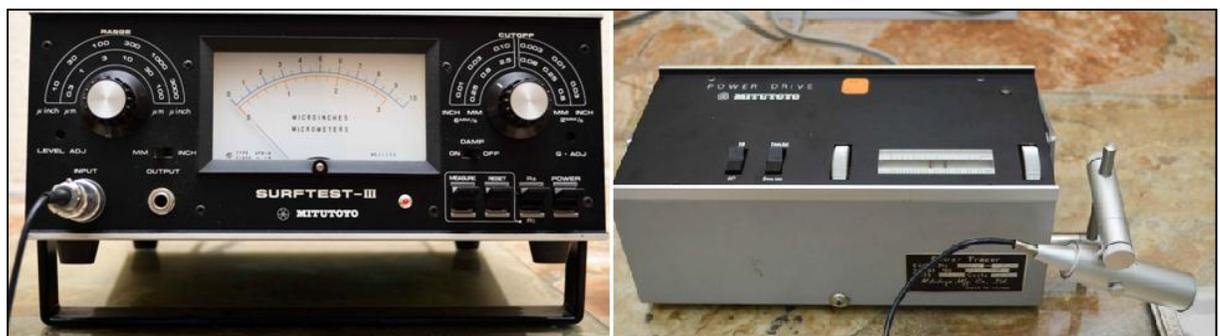
**Figura N. 12.** Rugosímetro Mitutoyo SurfTest III. Laboratorio de Metrología ESPE.
