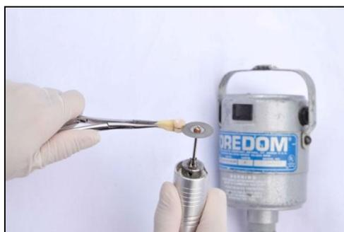
**Figura N. 4.** Coronas dentales cortadas con motor Freedom y disco de diamante.
