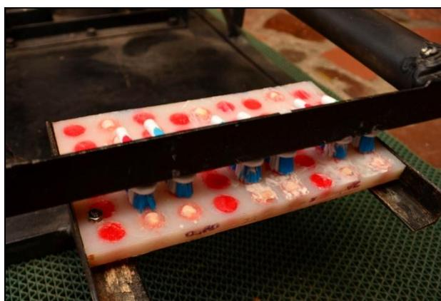
**Figura N. 7.** Segmentos cortados de esmalte asegurados a platina plástica removible.
