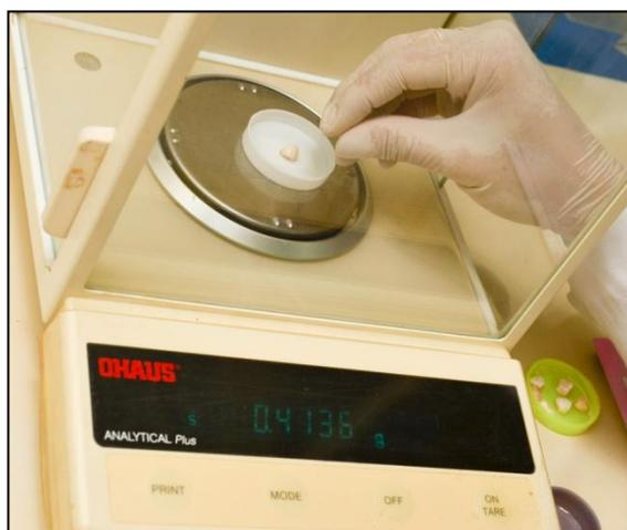
**Figura N. 5.** Segmentos cortados de esmalte en balanza digital de precisión.
