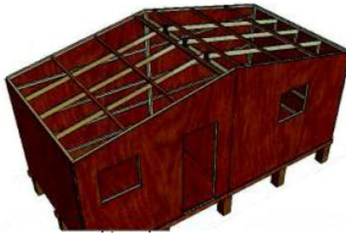
Figura 9: Estructura del techo
