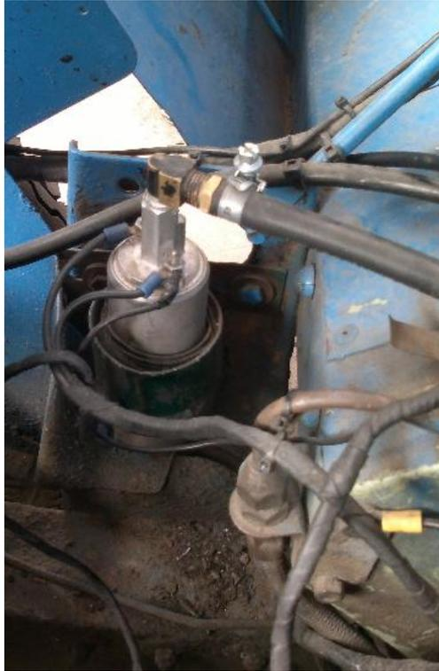
**Fotografía No. 8 Sujeción de la bomba en la carrocería**
