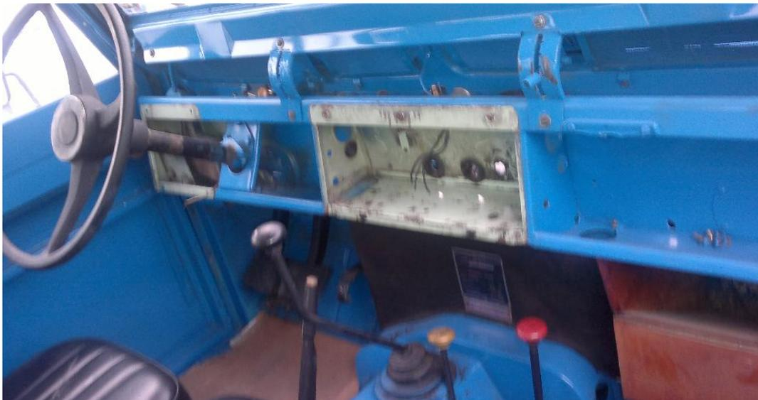
**Fotografía No. 19 Eliminación del cableado del tablero**
