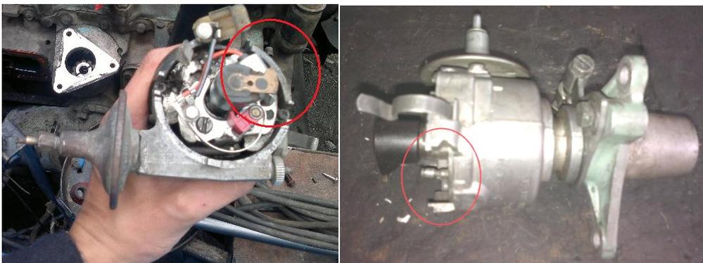
**Fotografía No. 49 Fractura del distribuidor**
