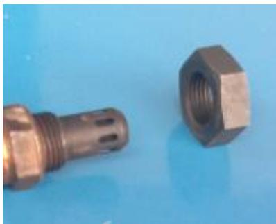
**Fotografía No. 34 Acople del sensor**
