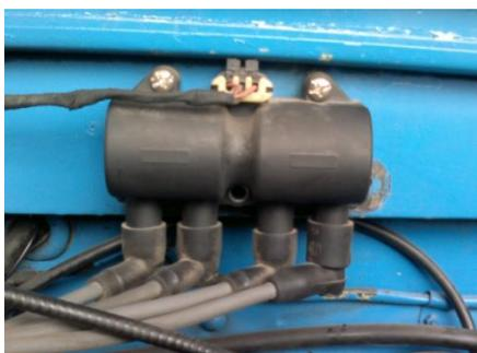
**Fotografía No. 55 Instalación de la bobina**
