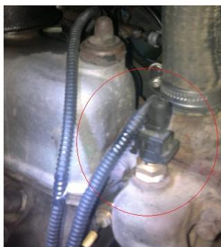
**Fotografía No. 32 Sensor temperatura del Agua**
