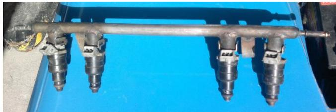
**Fotografía No. 42 Acople de inyectores en riel**
