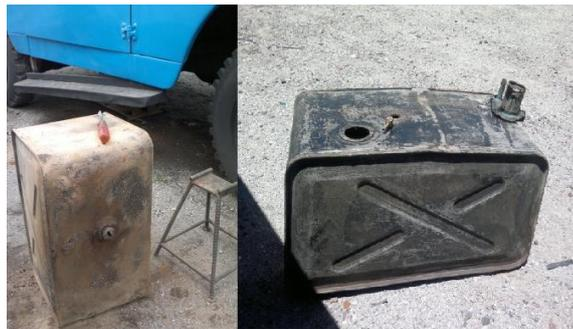
**Fotografía No. 2: Desmontaje del tanque**
