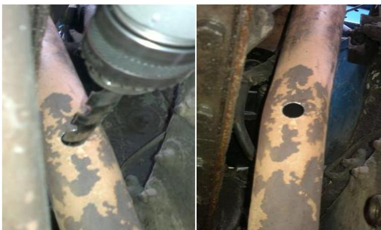
**Fotografía No. 35 Perforación del tubo de escape**
