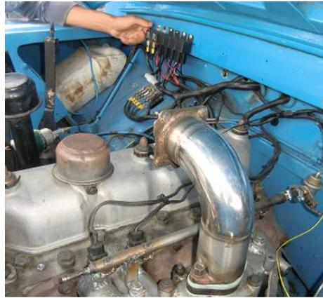
**Fotografía No. 46 Instalación de relé**
