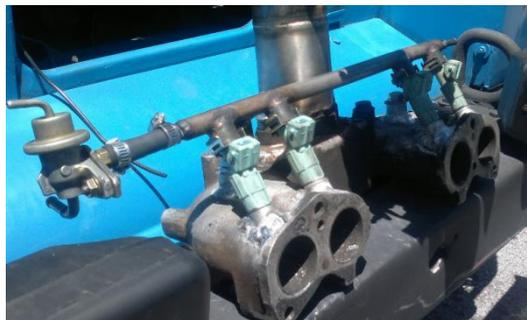
**Fotografía No. 43 Acople de inyectores en múltiple**
