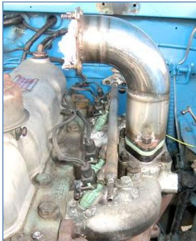
Fotografía No. 57 Ducto de aire adaptado
