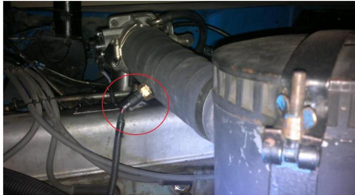
**Fotografía No. 30 Posición del sensor ATS**
