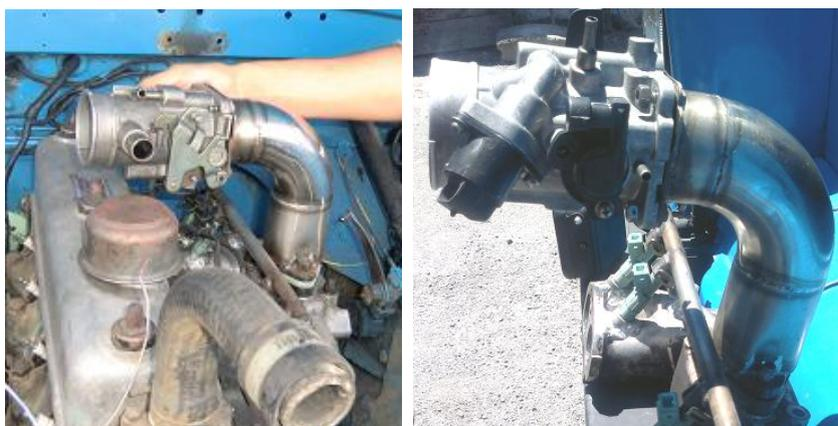
**Fotografía No. 59 Instalación del cuerpo de aceleración**
