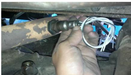
**Fotografía No. 36 Medición de posición del sensor**
