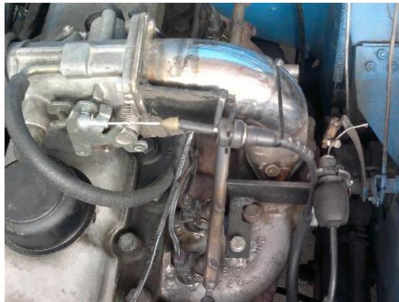
**Fotografía No. 62 Adaptación del cable de aceleración**
