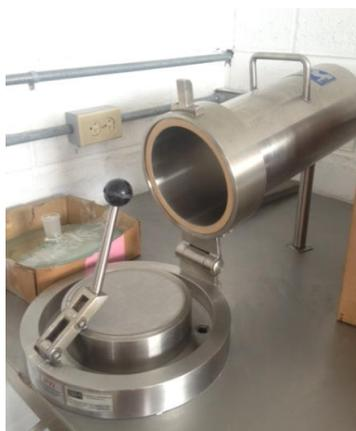
En este equipo se modela la agitación que realiza la maquinaria a nivel de proceso. Se vierte agua dentro del tanque, se procede a ingresar la mezcla de celulosa con reciclado y los químicos. Por último, se expulsa toda el agua. Al final del estanque en la plataforma quedan las fibras agrupadas de papel.
