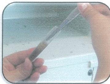
Fig. 52.— Retiro de los elásticos del tubo de ensayo con la pinza quirúrgica, colocación del ejemplar en la maquina para proceder a traccionarlo.
