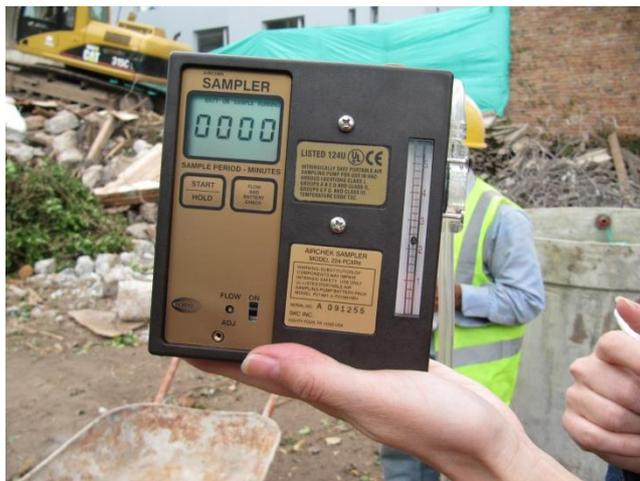
Fotografía N° 3.2.1: Bomba de muestreo, AirCheck Sampler
