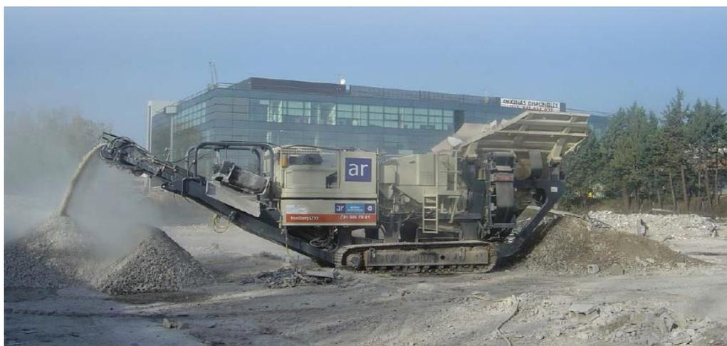
Fotografía N° 4.3.8: Planta de tratamiento y trituración móvil de escombros.
