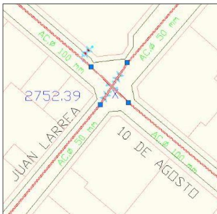
(a) **Figura 3.1:** Plano AutoCAD de tuberías de agua potable
