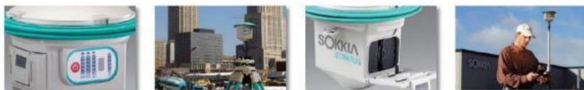
Estas mediciones se deben hacer al ubicar el instrumento en el elemento de red, adquirir la coordenada (x, y) y reSIGtrarla en un formato donde puedan ser leídas por un programa para generar automáticamente la cartografía de esos elementos. La definición del formato de estas coordenadas va a depender del programa que se utilice para leer y generar los objetos, siendo el formato ASCII el más común para los diferentes programas y equipos.
