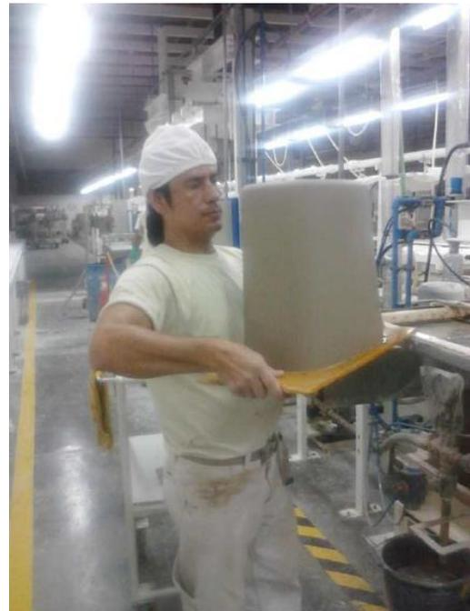
**Figura 30.** Desmolde de piezas, a la izquierda el pistón neumático y a la derecha el transporte.
