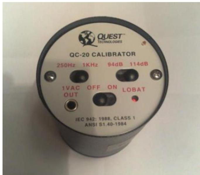
**Figura 28.** Calibrador marca 3M modelo QC-20
