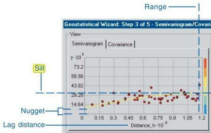
Gráfico 2. Partes de un semivariograma. Eje x, señala la distancia o lag entre parejas de puntos. Eje y, señala el valor de la semivarianza entre bins (parejas de puntos). Cada punto rojo señala la semivarianza entre cada pareja de puntos comparados. La línea amarilla es el ajuste empírico del modelo. Range: rango; sill: umbral; nugget: efecto pepita; Lag distance: distancia de comparación entre parejas de puntos. Fuente: (Johnston et al., 2003).
