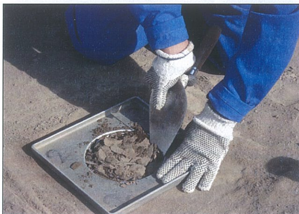
Figura 3.5.- Excavación del agujero.
