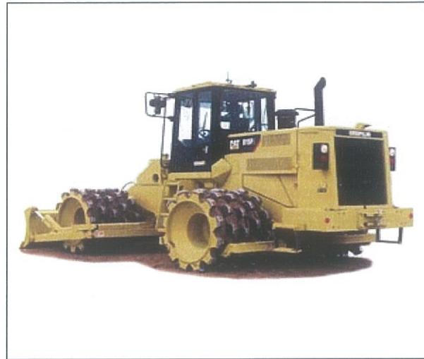
Figura 2.19.- Rodillo pata de cabra ( http://mexico.cat.com ).
