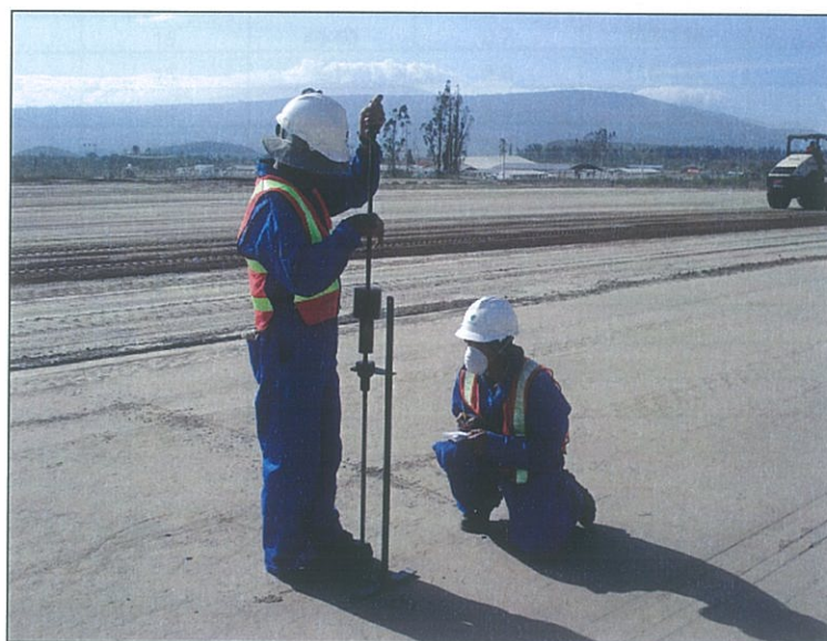
Figura 3.18.- Realización del ensayo DCP.
