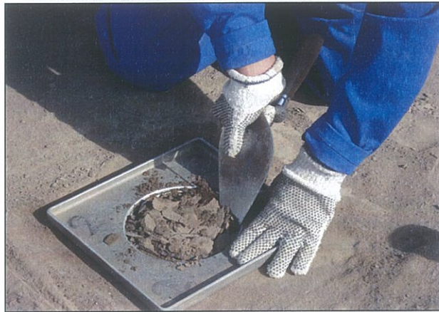
Figura 3.5.- Excavación del agujero.
