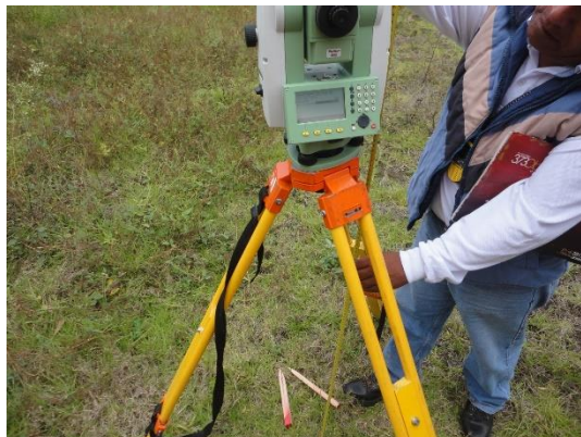
Figura 4. Estación Total Leica Flexline TS06 plus.
