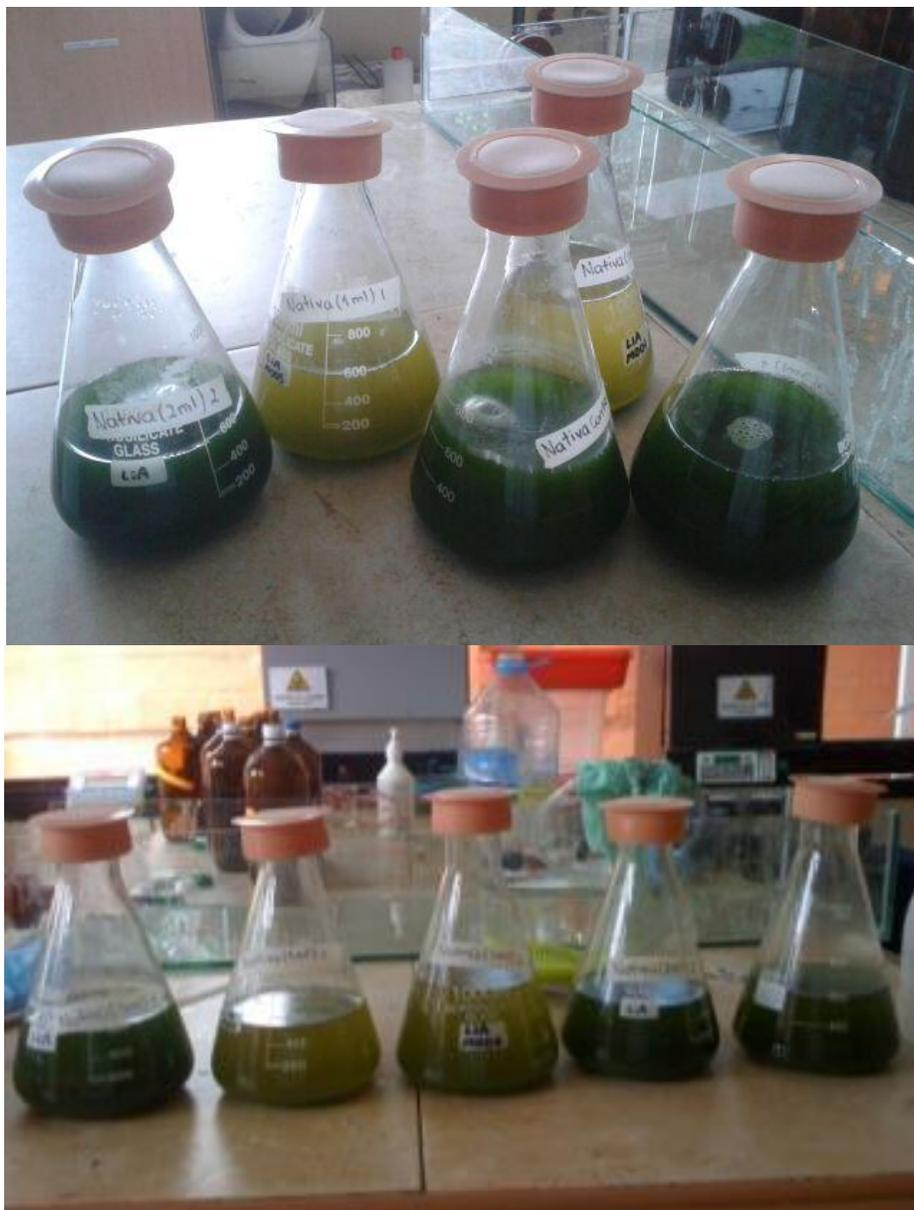
**Figura 23.** Fotografías de los bioensayos batch de 500 mL para evaluar el efecto del fertilizante en el contenido de lípidos de la microalga *Chlorella sp.* Los bioensayos se mantuvieron a 25°C, con ciclos de 12 h de luz y 12 h de oscuridad con lámparas OSRAM de luz fluorescente blanca fría de 20 W, agitación continua a 50 rpm utilizando un agitador orbital en un tiempo de cultivo de 8 días.
