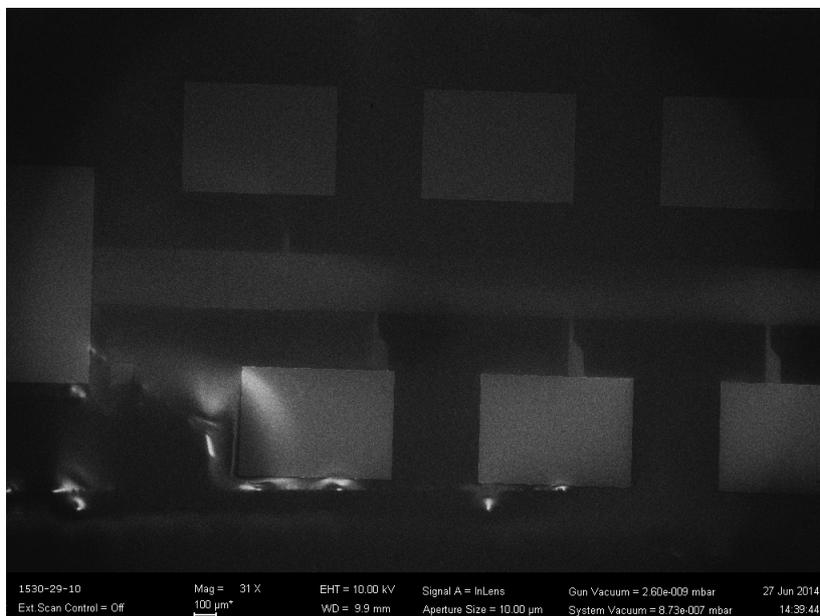
Figura 23: Muestra de LCMO después de la deposición de los contactos de oro vista en un microscopio electrónico de barrido.
