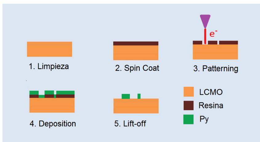
Figure 13: Esquema del proceso de litografía. Primero se limpia la muestra, se la cubre con resina (spin coat), se realiza la exposición con el litógrafo (patterning), se deposita el material y se quita la resina (lift-off).
