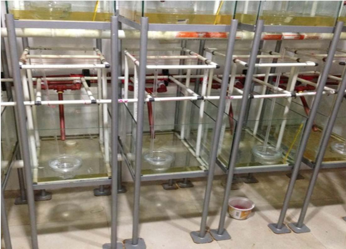
**Figura 2** Bowls o tazones con larvas colocados en peceras a diferentes temperaturas, 19-22 grados C y 26-28 grados C. Sistema de tuberías con llaves para transporte de agua fría y caliente.
