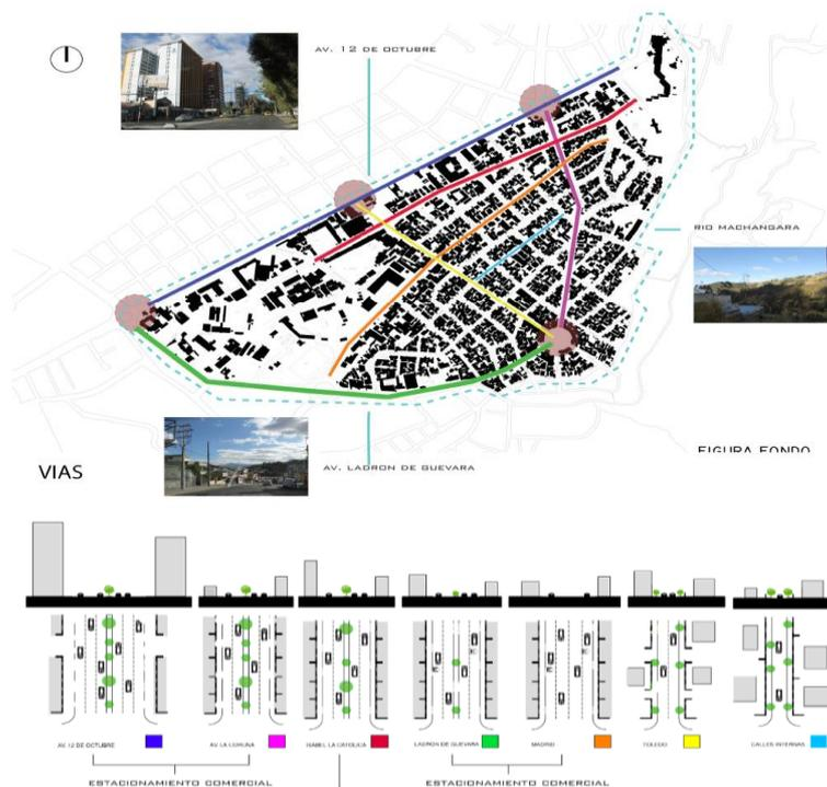
Figura 3: Clasificación de vías internas. Planta y Corte. Elaboración Grupal.2015
