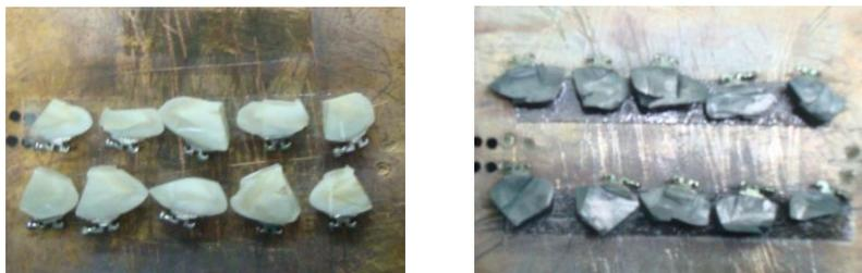
Figura 20 Muestras montadas sin y con recubrimiento en oro
