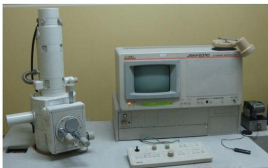
Figura 11 Microscopio electrónico de barrido
