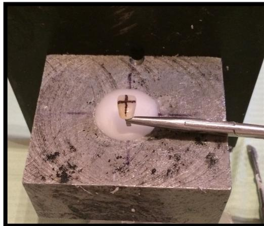
Figura 11. Centro del dispositivo de acero. Figura 12. Colocación de la corona de porcelana en el centro del cilindro de acrílico.
