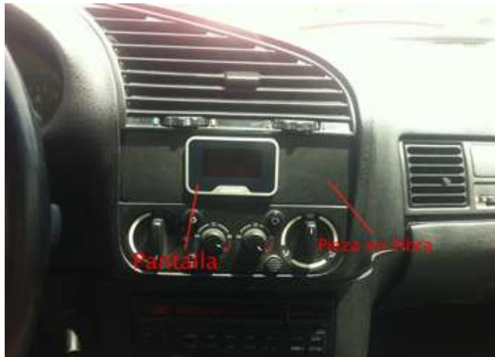
**Fig. 90 Ubicación de la pantalla en la pieza hecha en fibra**
