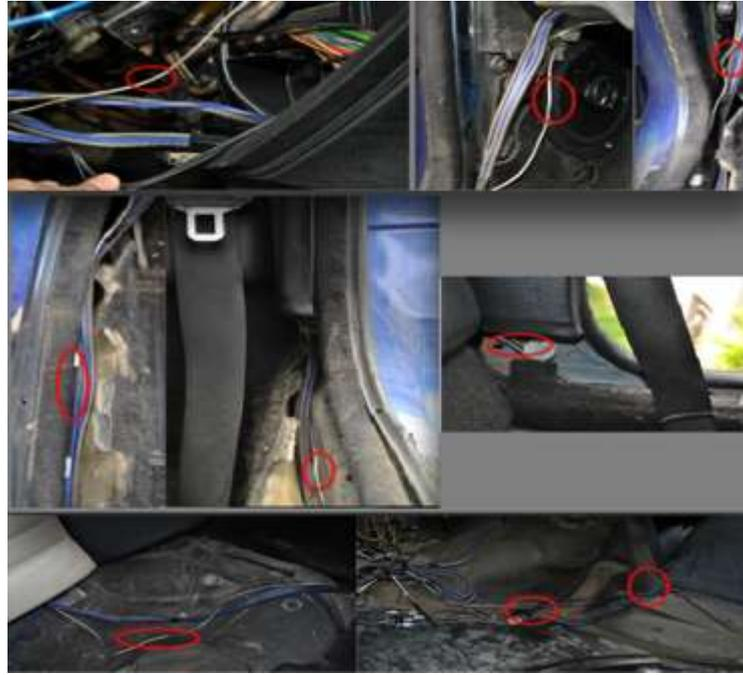
**Fig. 55 Paso del cable remoto por la parte interna del vehículo**
