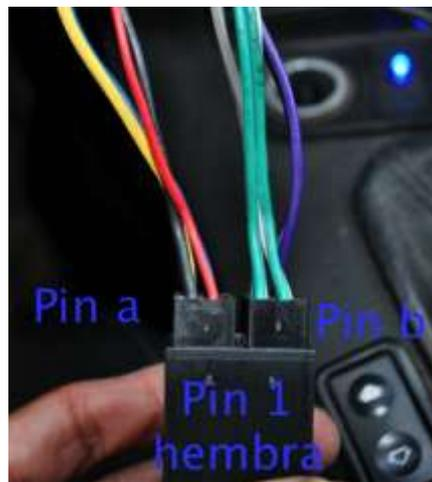
**Fig. 46 Pines de entrada "a" y salida "b"**
