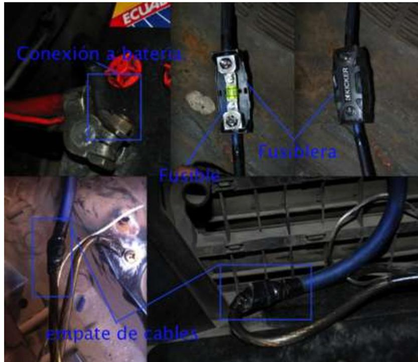
Fig. 75 Conexión cable de corriente positiva del amplificador
