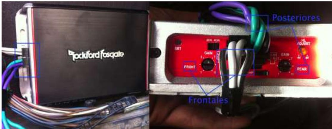
**Fig. 71** Conexión de los sockets de entrada de audio del amplificador
