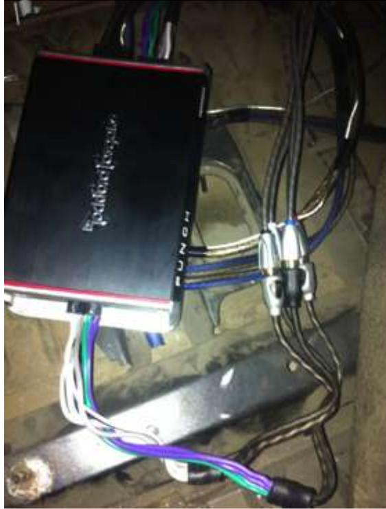
**Fig. 67 Conexión de cables al amplificador PUNCH**
