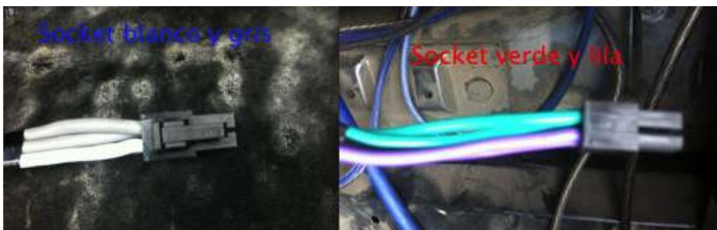
**Fig. 80 Sockets 2 y 3, salidas de audio del amplificador**
