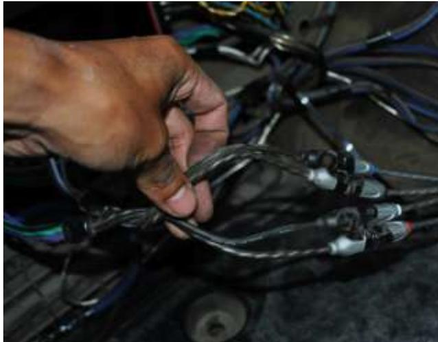
**Fig. 68 Conexión de cables RCA al Amplificador PUNCH**
