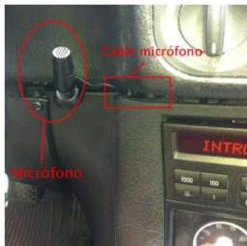
**Fig. 89 Ubicación del micrófono y paso del cable**
