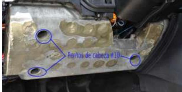
**Fig. 31 Desmontaje del panel de aluminio del lado izquierdo**
