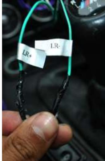
**Fig. 60 Empate canales de audio LR-/LR+ con el convertidor de impedancia**
