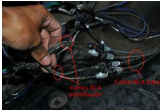
**Fig. 65 Conexión de Cables RCA de Salida del convertidor Raptor a los RCA de entrada del amplificador PUNCH**
