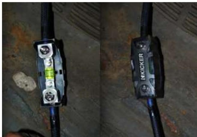
Fig. 76 Fusible y porta fusible del amplificador
