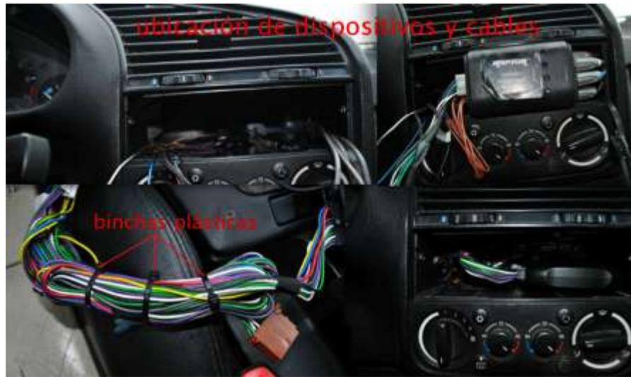
**Fig. 92** Ubicación de los dispositivos y cable sobrante en el interior del vehículo
