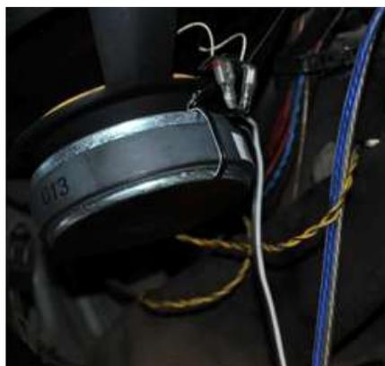
**Fig. 86 Conexión correcta a los altavoces**
