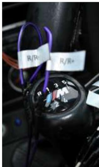
**Fig. 59 Empate canales de audio R/R-, R/R+ con el convertidor de impedancia**
