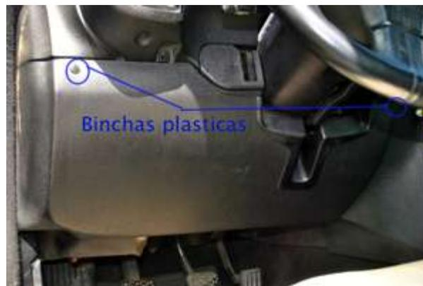
Fig. 30 Desmontaje del panel pastico inferior del lado izquierdo
