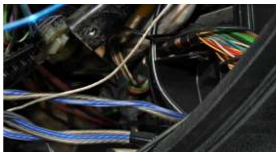
**Fig. 53 Paso de cables por el interior del tablero.**
