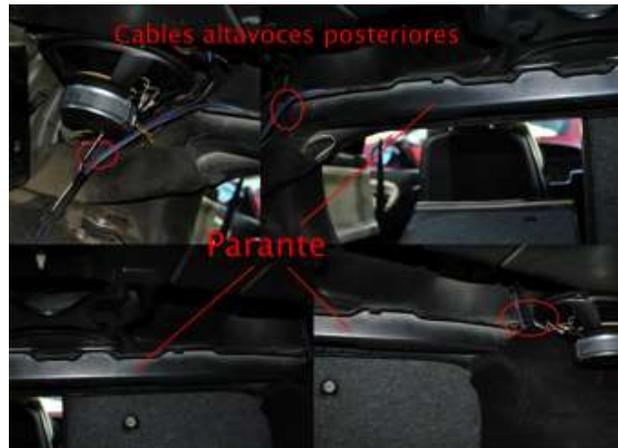
Fig. 83 Paso del cable Corneta 16 por el interior del vehículo, altavoces posteriores.
