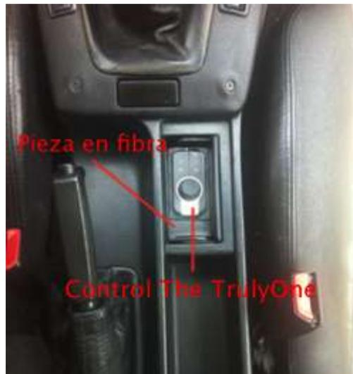
**Fig. 91 Ubicación del control en la pieza en fibra**
