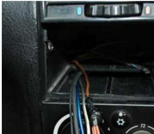
**Fig. 51 Paso de cables por el interior del tablero**
