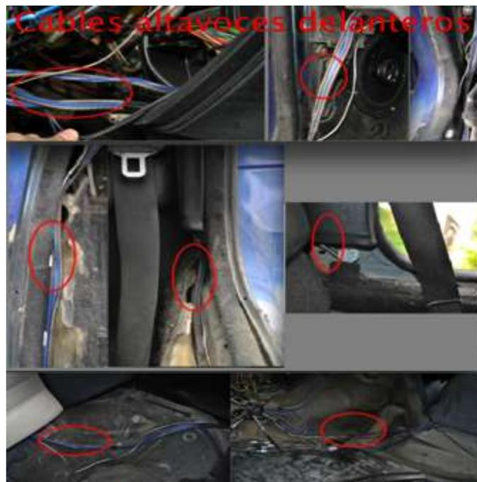
**Fig. 82** Paso del cable Corneta 16 por el interior del vehículo, altavoces delanteros.
