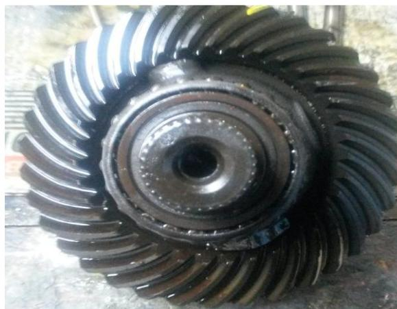
**Imagen 88.- Mecanismos diferencial: cono y corona transmisión posterior Volkswagen**
