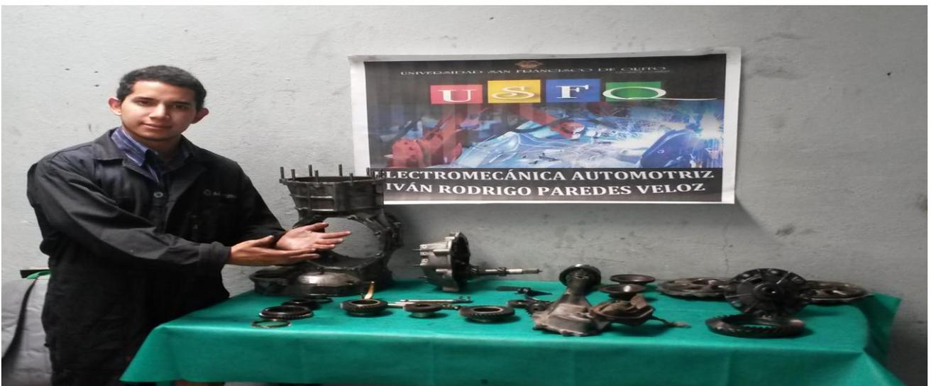
**Imagen 87.- Transmisión posterior Volkswagen totalmente desarmada**
