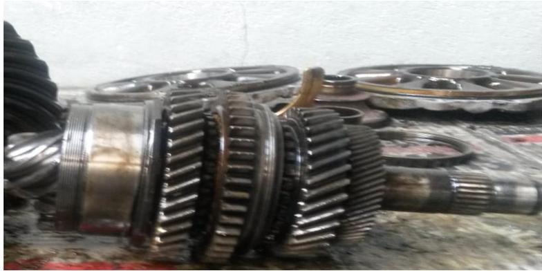
**Imagen 86.- Piñonería eje de entrada transmisión Volkswagen**
