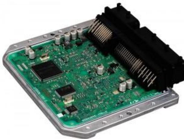
**Imagen 18.- Módulo transmisión automática**
