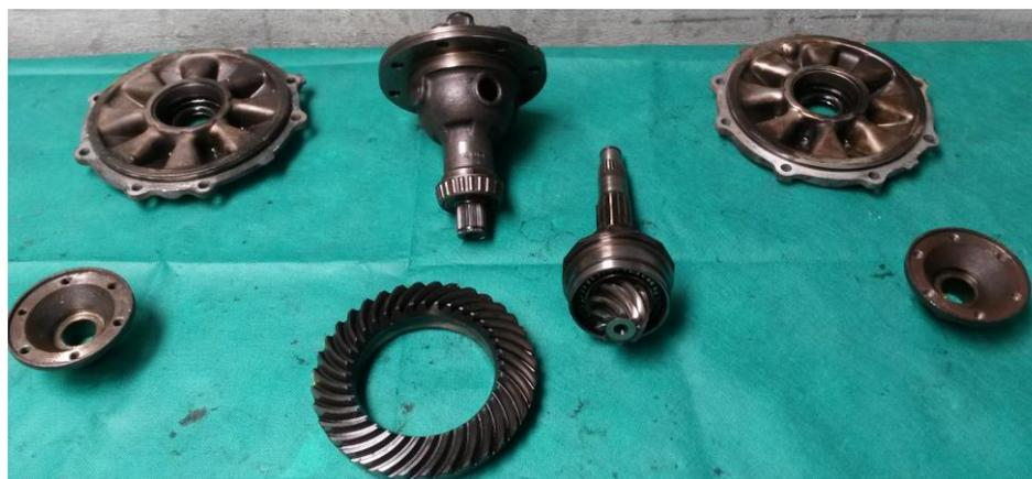
**Imagen 89.- Mecanismo diferencial desarmado transmisión posterior Volkswagen**
