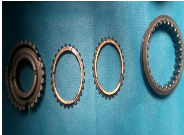
**Imagen 69.- Mecanismo sincronización Datsun**
