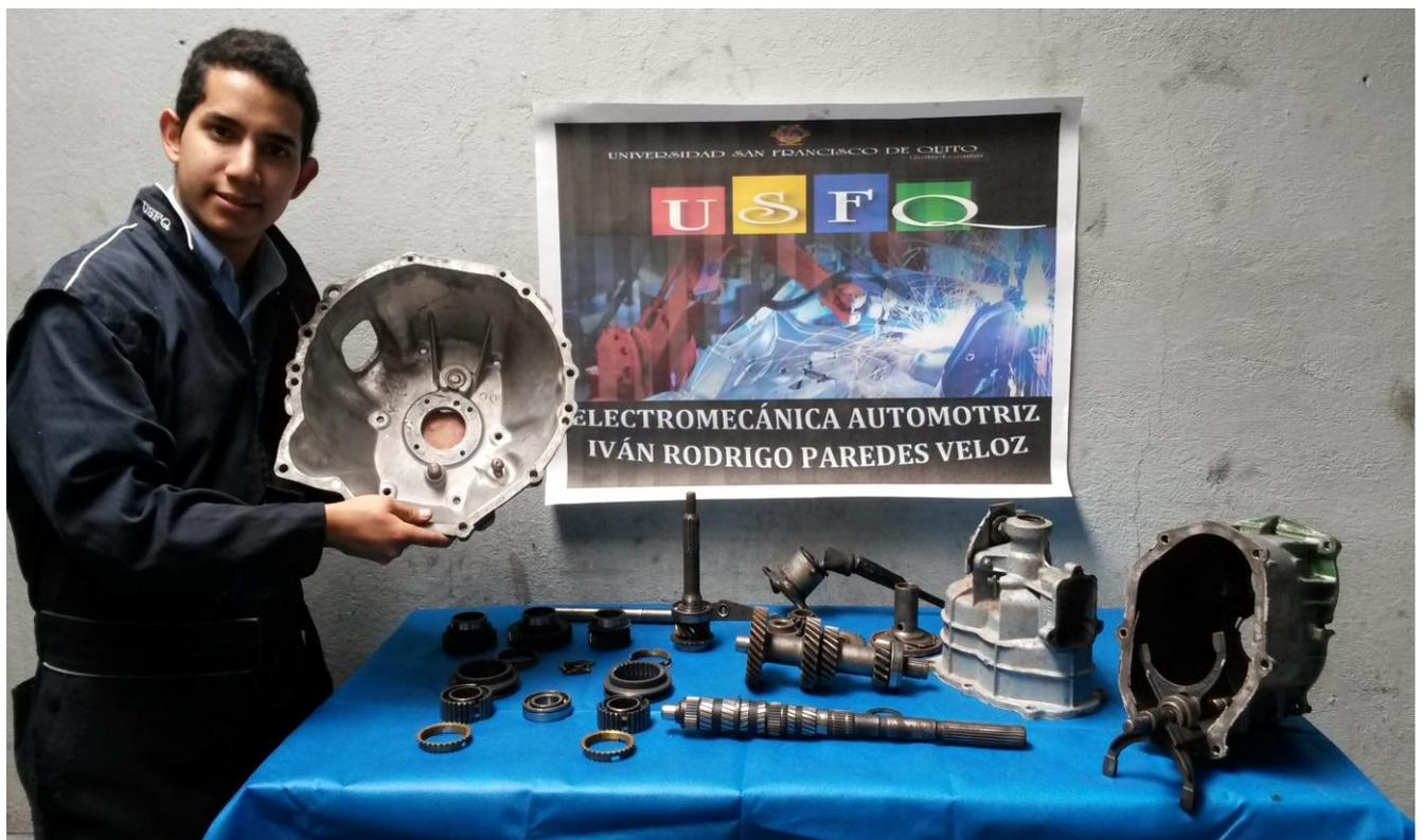
**Imagen 76: Transmisión posterior San Remo totalmente desarmada**
