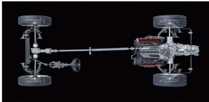
**Imagen 23.- Motor trasero y propulsión**
