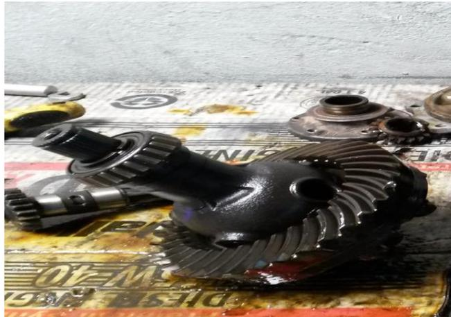
**Imagen 84.- Mecanismo diferencial transmisión Volkswagen**
