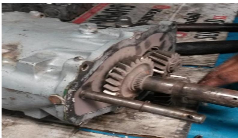
**Imagen 74.- Desarmado piñonería reversa transmisión San Remo**
