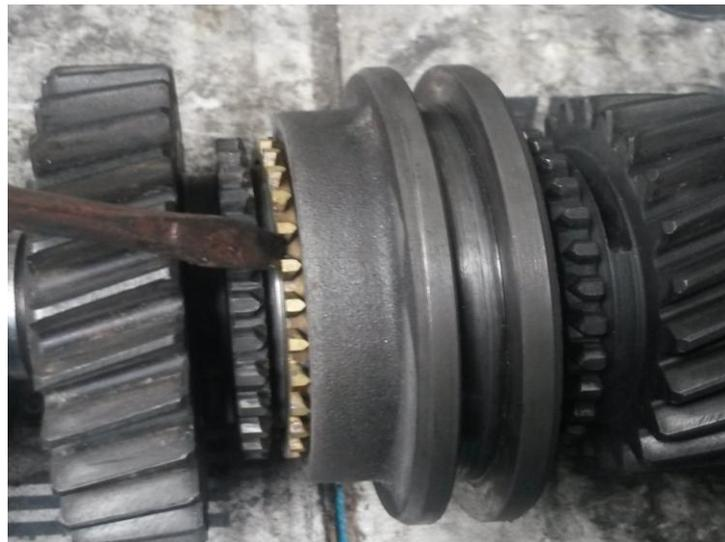
**Imagen 78.- Dispositivo sincronización transmisión San Remo**
