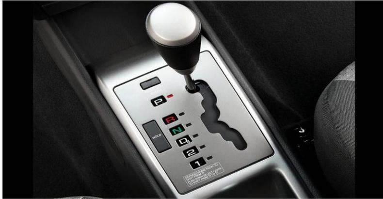
**Imagen 20.- Palanca selectora de marchas transmisión automática**
