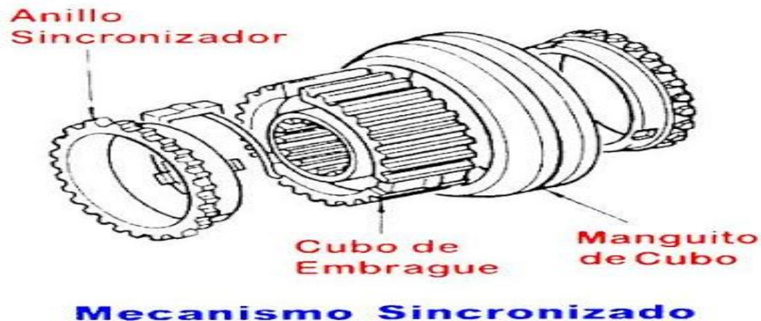
**Imagen 38.- Elementos constitutivos del mecanismo de sincronización**
