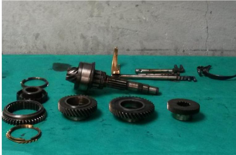
**Imagen 92.- Piñonería y mecanismos de sincronización transmisión posterior Volkswagen**
