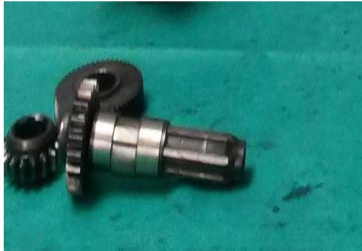
**Imagen 91.- Piñonería reversa transmisión posterior Volkswagen**
