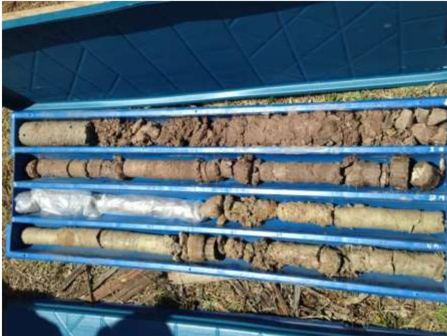
Figura 30, Testigos obtenidos de perforación
