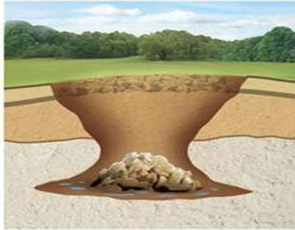
Figura 10, Hundimiento por subsidencia (USGS, 2004).
