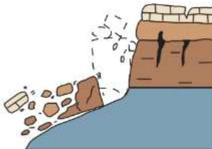
Figura 7, Volcamiento de roca (USGS, 2004).
