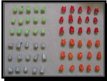
Figura 17: Impermeabilización de las muestras
