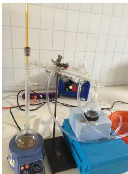
**Figura 3.9: Sistema de destilación para análisis de AGV**
