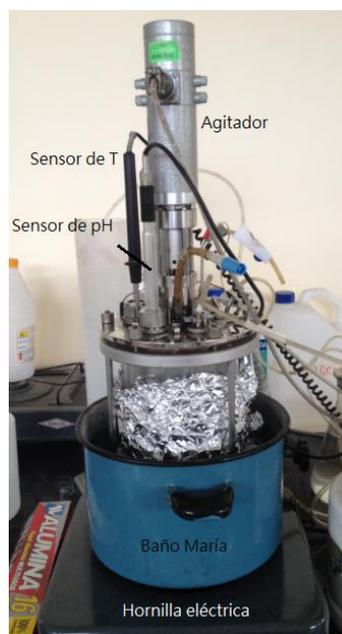
**Figura 3.2: Biodigestor aplicado**
