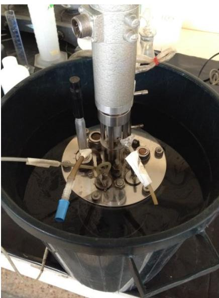
**Figura 3.5: Prueba hidrostática del biodigestor**
