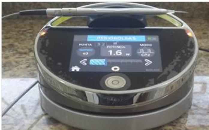
**Gráfico3. LÁSER DE DIODO (InGaAsP)**
