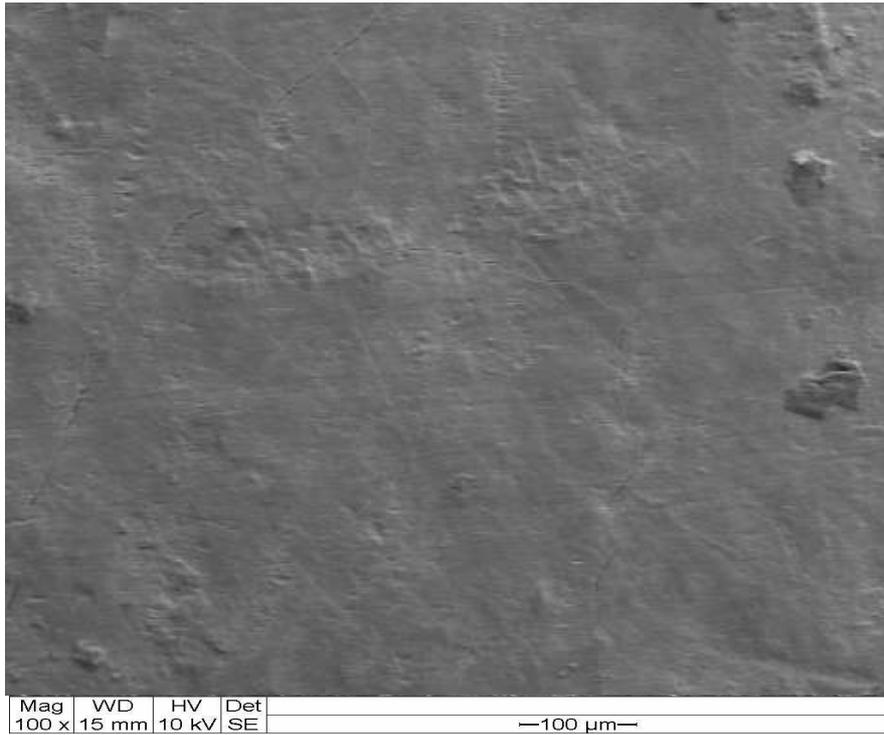
Fotografía MEB N° 7: *Superficie tratada con piezoeléctrico, magnificación 100X*
