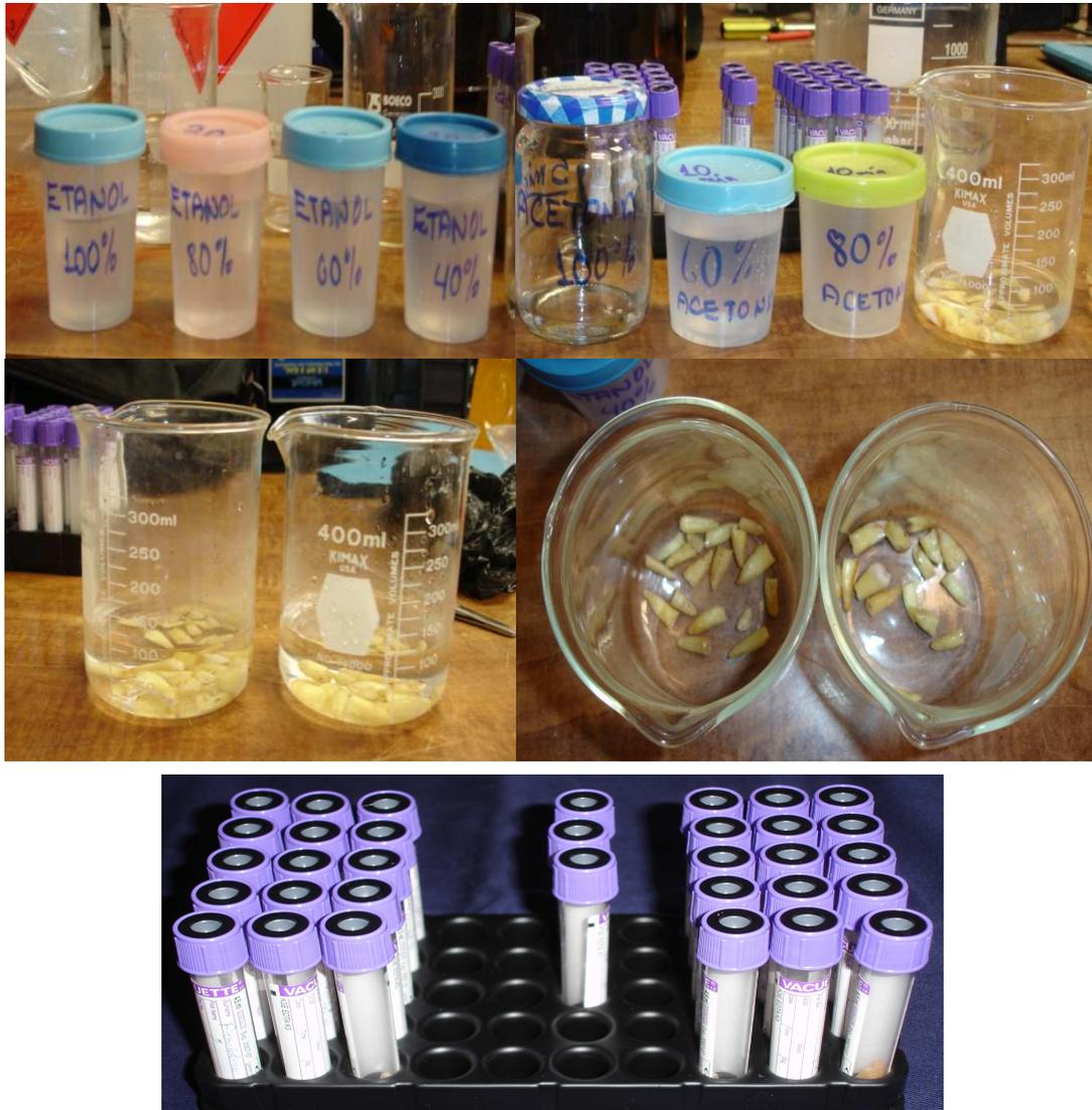
**FOTOGRAFIA 7. Proceso de deshidratación de las muestras. Deshidratación mediante acetona en grados decrecientes,, deshidratación con etanol en grados crecientes**
