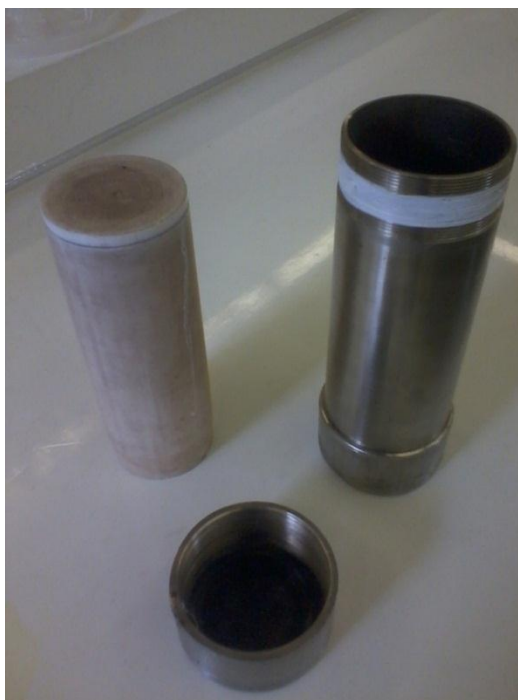
Figura 3.12 Reactor de teflón y acero inoxidable para tratamiento hidrotermal
