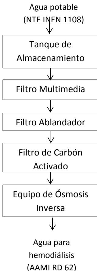
*Figura 4.1: Diagrama de bloque de la planta de tratamiento de aguas del Centro de Diálisis*
