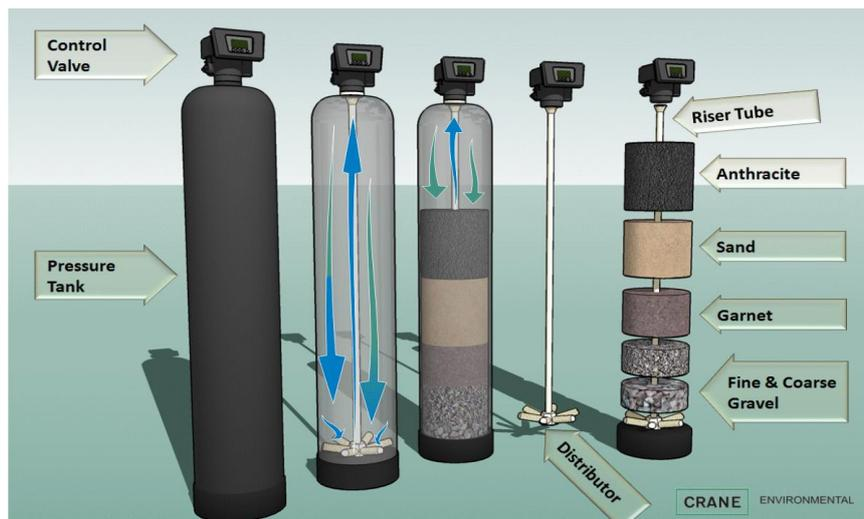
*Figura 4.3: Esquema de la configuración de un filtro multimedia (Unitek, 2010)*
