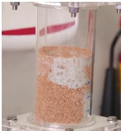
**Fig. 4.26: Lecho completamente mezclado después de ser fluidizado**
