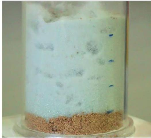
**Fig. 4.18: Lecho en proceso de fluidización**
