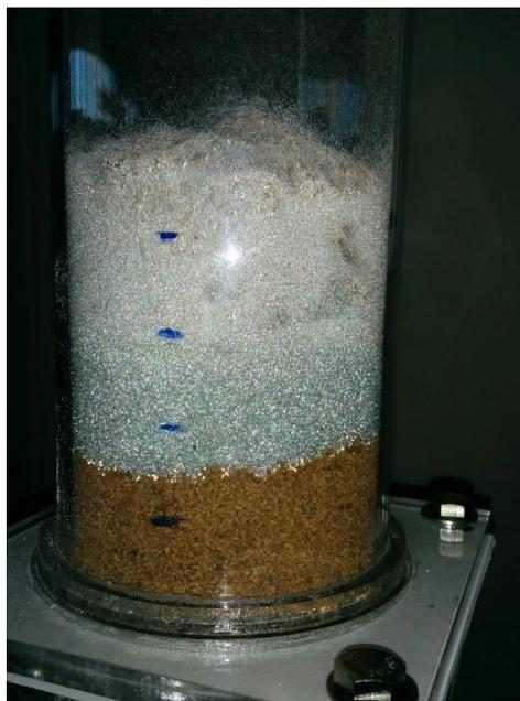
**Fig. 4.20: Lecho en proceso de fluidización**
