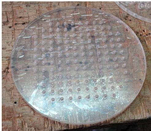
**Fig. 3.4: Sección del plato distribuidor con agujeros de 2 mm.**
