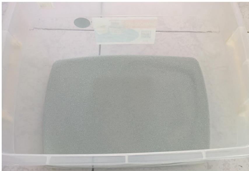
**Fig. 4.6: Microesferas tamizadas**
