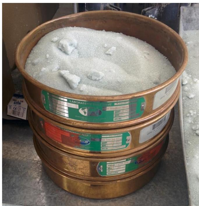
**Fig. 4.5: Microesferas a ser tamizadas**
