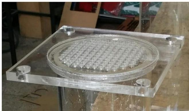
**Fig. 3.13: Brida del Plato Distribuidor**
