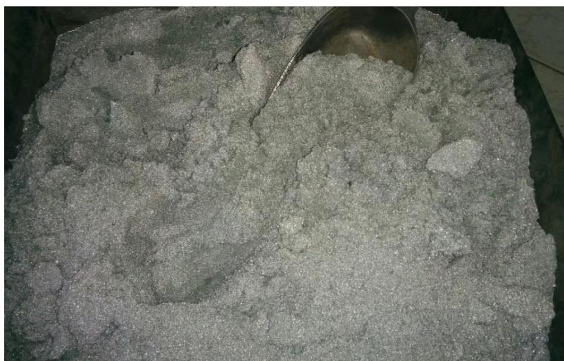
**Fig. 4.2: Microesferas de vidrio antes de ser secadas en el horno.**
