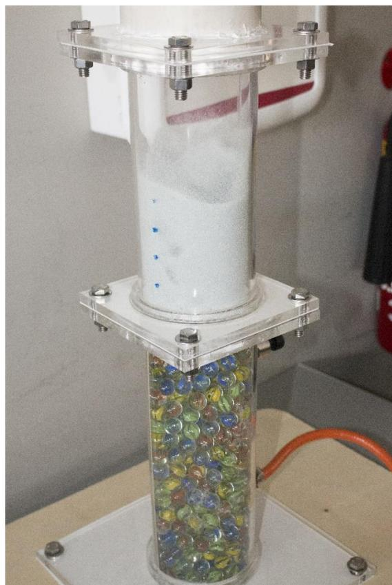
**Fig. 4.13: Prueba del Reactor para encontrar la presión de fluidización.**
