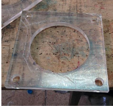
**Fig. 3.2: Brida cortada con láser en Gamacril**
