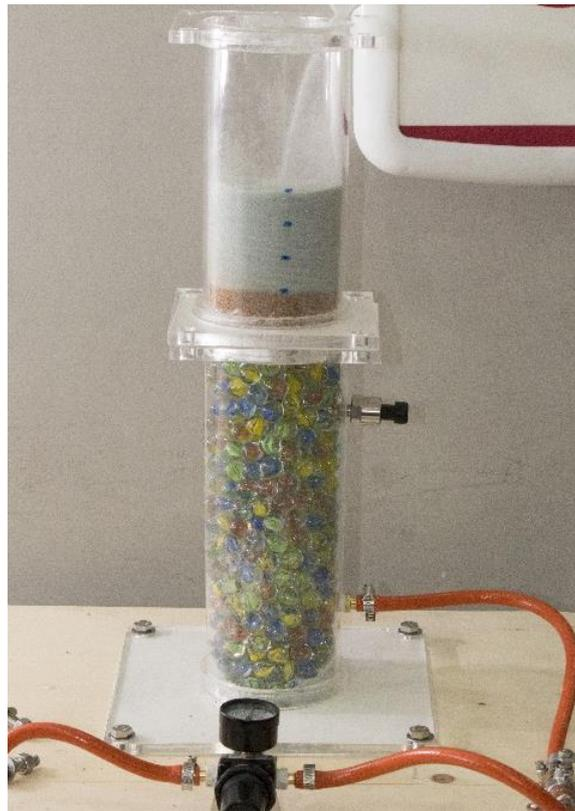
**Fig.4.14: Preparación del Lecho antes de ser fluidizado**
