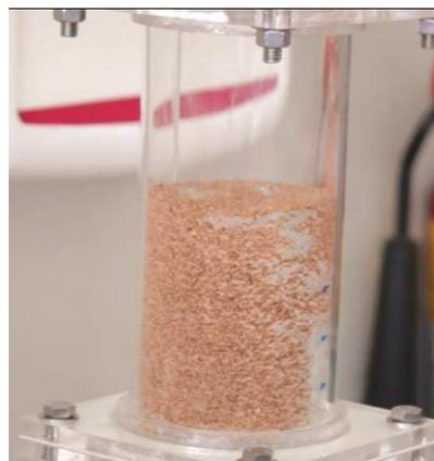
**Fig. 4.25: Lecho completamente mezclado antes de ser fluidizado**
