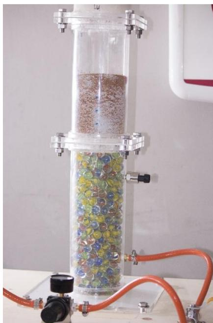
**Fig. 4.27: Lecho Fluidizado con condiciones iniciales de lecho mezclado**
