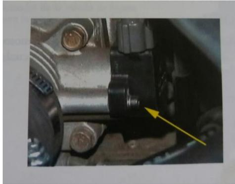
**Figura10. Potenciómetro de la mariposa TPS**
