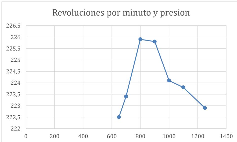
En este gráfico podemos apreciar que la presión del aire mientras van bajando las revoluciones desde 1251 hasta 650 la presión varía muy poco, solo varía 3 mmHg, esta prueba está realizada en fase de calentamiento del vehículo.
