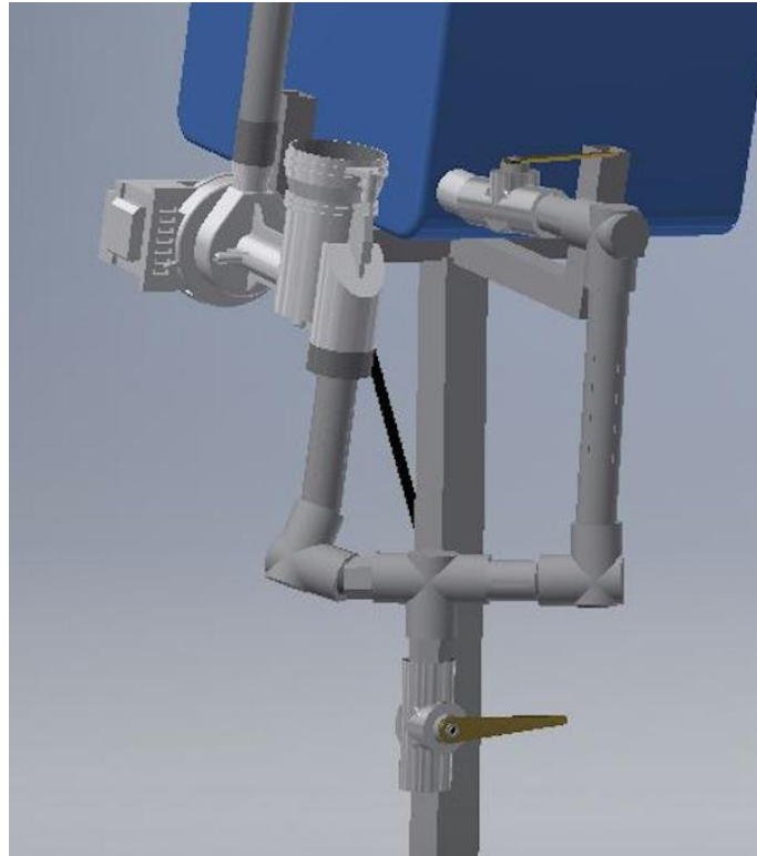
Figura 13. Vista válvulas y bomba tanque C
