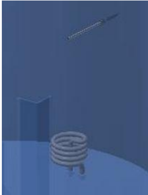
Figura 8. Vista niquelina tanque A
