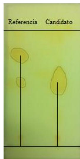
Ilustración 3 Cromatografía de capa fina, en el lado izquierdo biodiésel de referencia y en el lado derecho el biodiésel candidato
