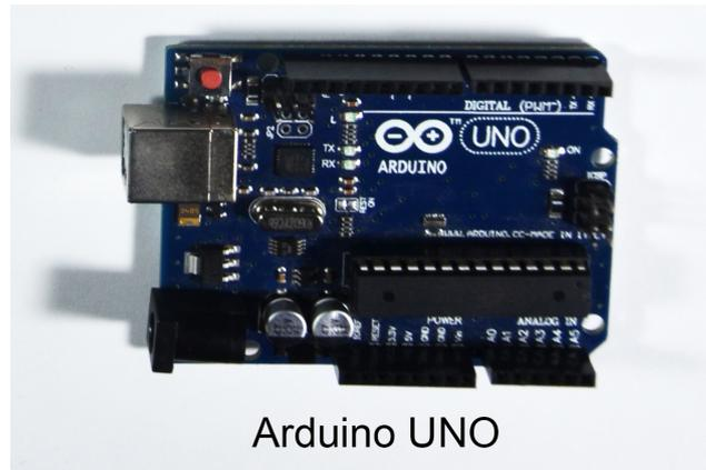
*Figura 2: placa electrónica Arduino UNO*
