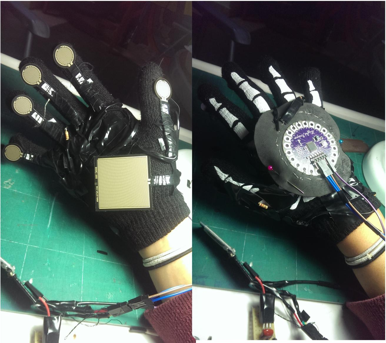
*Figura 37: Adaptación de sensores y placa al guante.*
