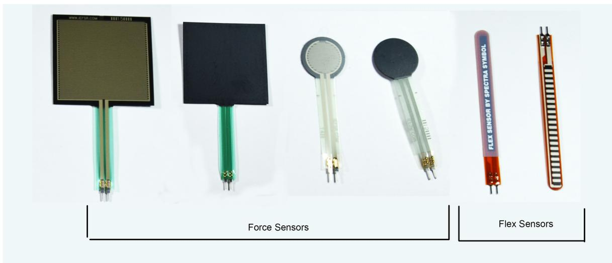
*Figura 3: Foto de sensores de fuerza (izquierda), sensores de flexión (derecha)*
