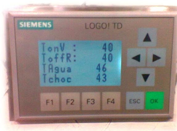
Figura 69.- Temperaturas indicadas en modo de operación manual, F2+F3
