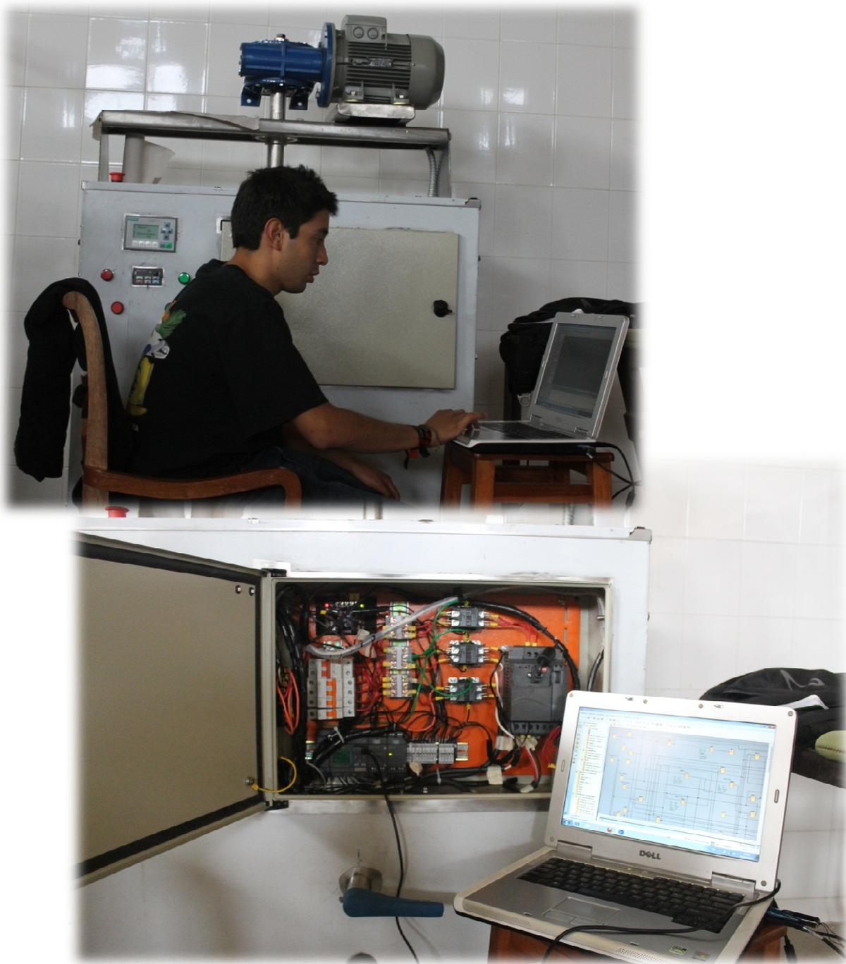
Figura 51.- Conexión PC – LOGO para descargar el programa
