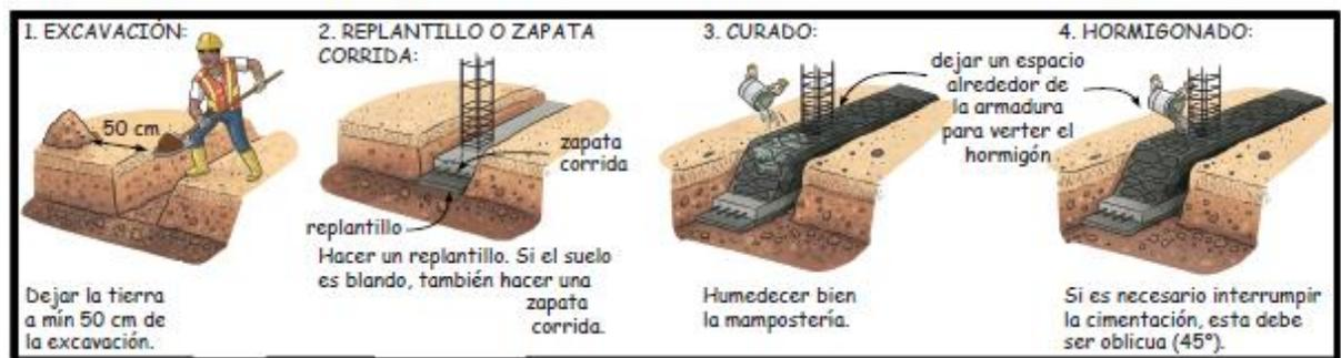
**Figura 6.** Proceso de construcción de cimentaciones corridas en mampostería confinada
