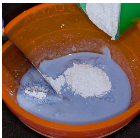
Imagen 18: Mezcla de yeso de alta resistencia, yeso tipo IV
