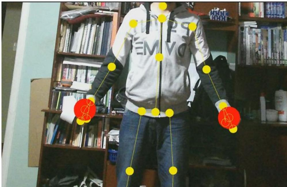
Figure 9. Tracking del cuerpo: KINECT
