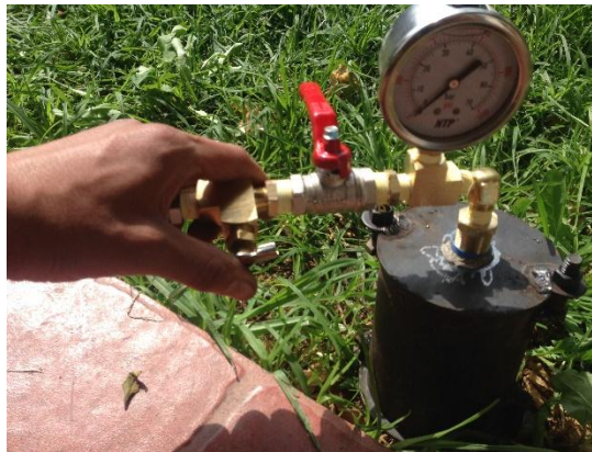
Figura 17: Componentes y uniones para Hidroconformado.
