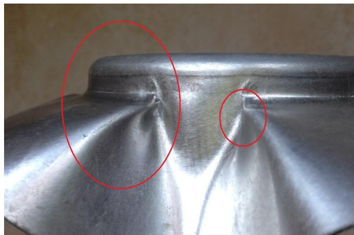
Figura 53: Inicio de Embutición y creación de Ondulaciones
