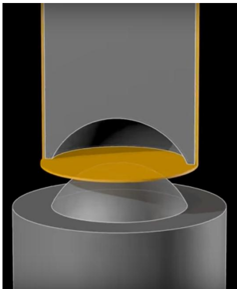
Figura 8: Matriz convexa y émbolo cóncavo para domo Inferior (Hammack)
