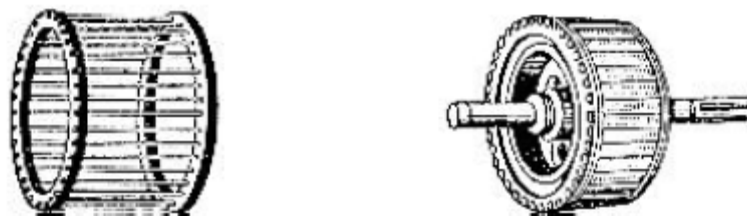
Figura 2.3. a) Jaula de Ardilla b) Rotor tipo Jaula de Ardilla. [9].
