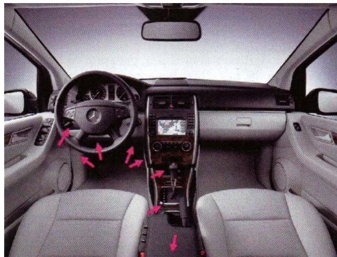
Figura 2.1. Posibilidades de localización del conector OBD-II en diferentes marcas y modelos.
