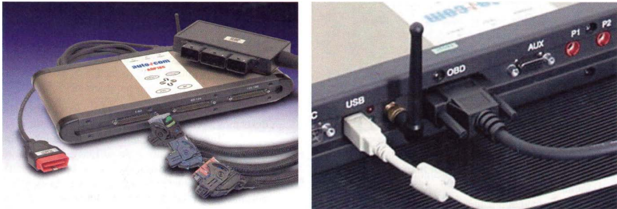
Figura 2.11. Ejemplo de dispositivo para la conexión en paralelo: MIACAUTOCOM. Fuente: Sistemas Eléctricos y de Seguridad
