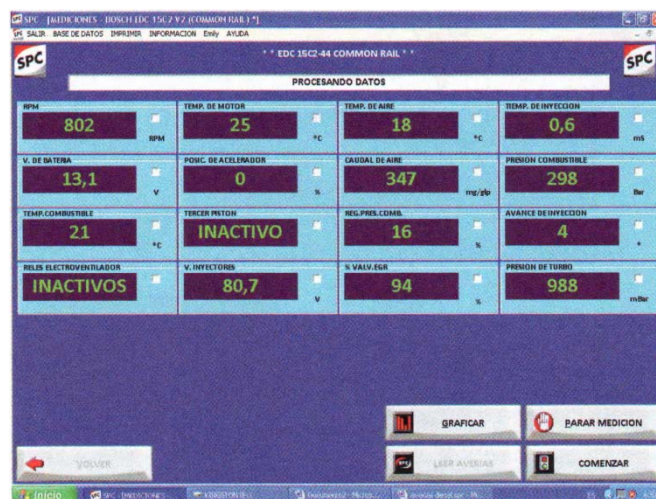
Figura 2.10. Informe de valores reales ofrecido por el aparato de diagnóstico KTS de BOSCH
