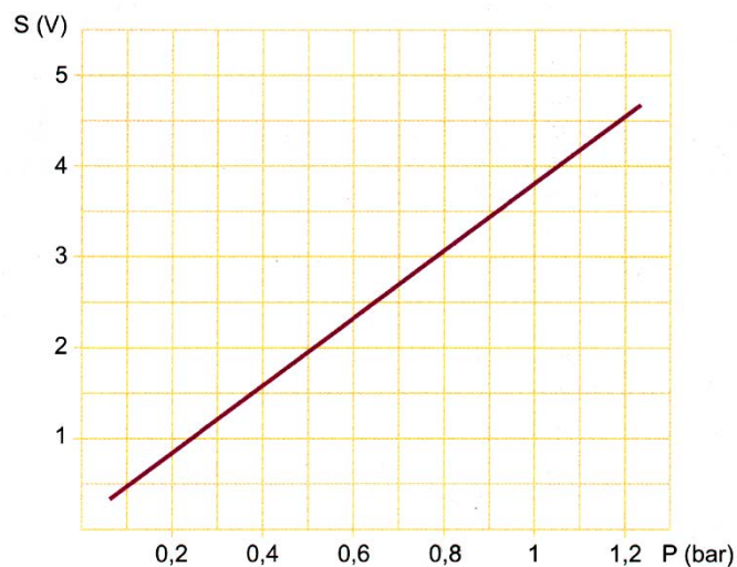
Figura 1.5. Curva característica de la tensión en en función de la presión sobre la piezorresistencia).
