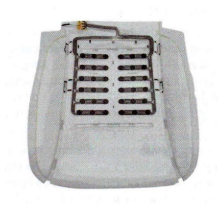
Figura 1.8. Sensor de ocupación del asiento, basado en piezorresistencias Fuente: Sistemas Eléctricos y de Seguridad
