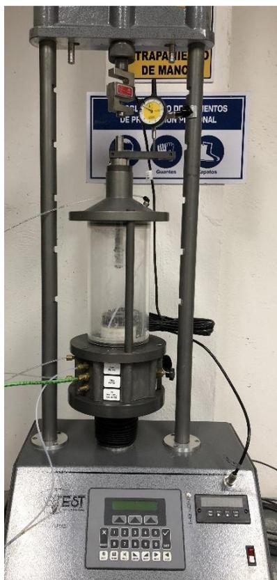
Figura A. 51: Celda triaxial en el marco de carga.
