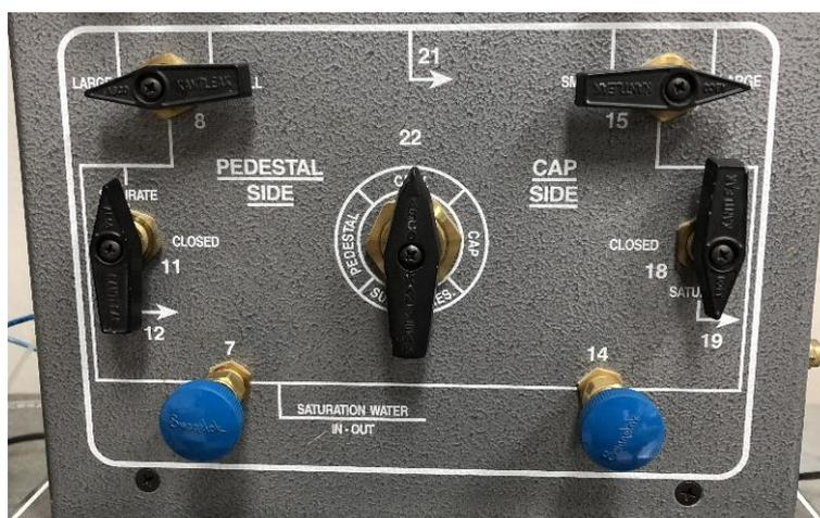
Figura A. 47 Posición de las manecillas de la columna triaxial superior abiertas las vías de agua del cap y pedestal.
