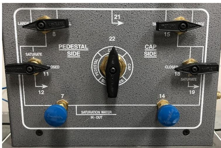
Figura A. 37 : Posición de las manecillas de la columna triaxial superior para llenar las buretas.
