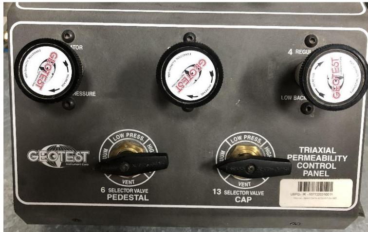
Figura A. 18: Posición de las manecillas de la columna triaxial inferior para llenar las buretas.
