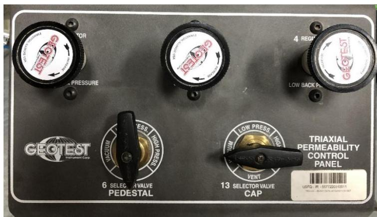
Figura A. 36: Posición de las manecillas inferior de la comuna triaxial aplicar la presión y que el agua percole hasta llegar al cap.
