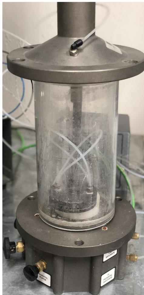
*Figura A. 3: Celda triaxial.*
