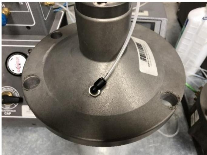
Figura A. 32: Acople rápido celda triaxial.
