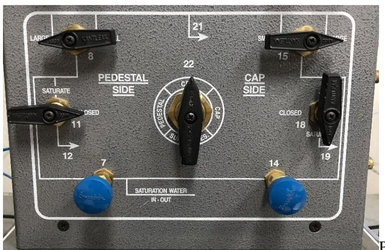
Figura A. 33: Configuración de manecillas de la columna de control superior para generar vacío en el cap.
