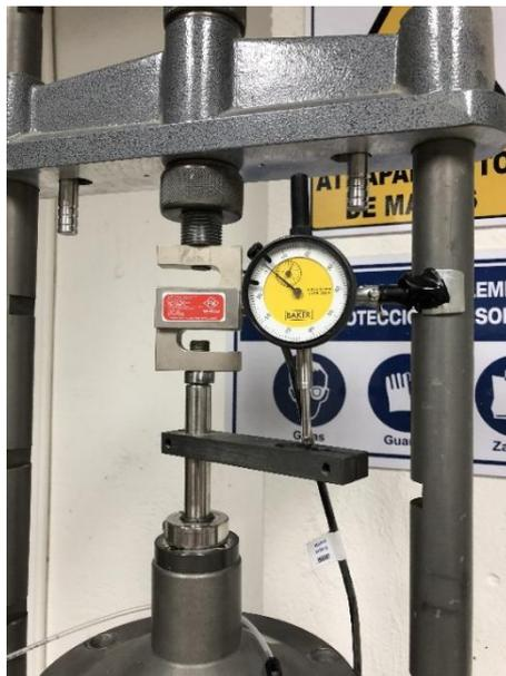
Figura A. 52: Celda triaxial colocada en el marco de celda y deformímetro en su posición.
