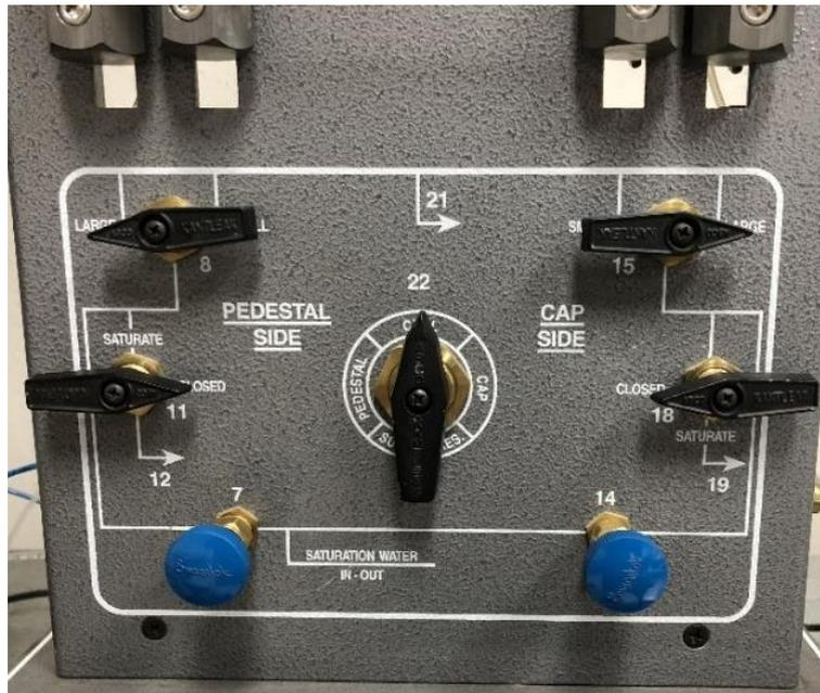
Figura A. 42: Configuración de manecillas cerradas de la columna de control superior.
