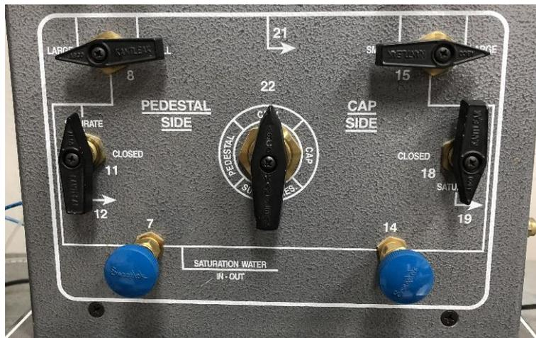
Figura A. 45: Posición de las manecillas de la columna triaxial superior abiertas las vías de agua del cap y pedestal.
