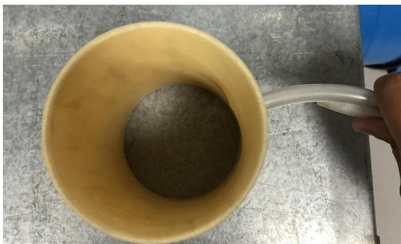
*Figura A. 22: Tubo de PVC y membrana luego de generar el vacío entre las dos.*
