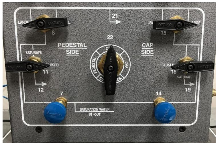
Figura A. 17: Posición de las manecillas de la columna triaxial superior para llenar las buretas.
