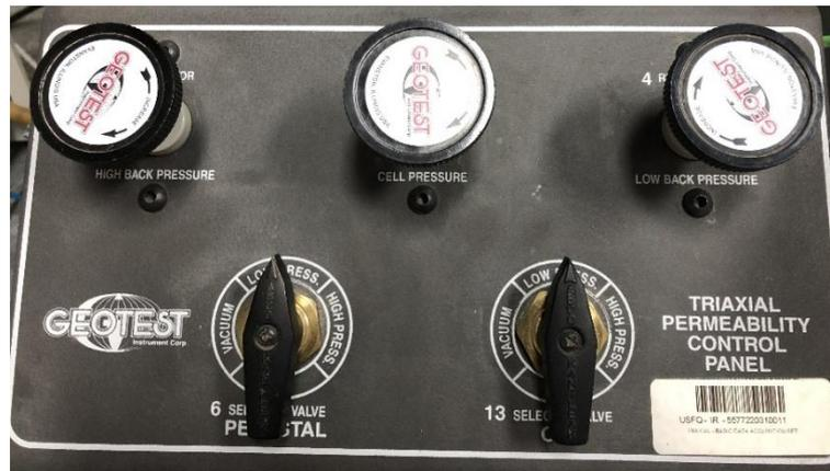
Figura A. 16: Configuración de manecillas de la columna de control inferior.
