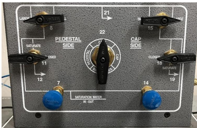
Figura A. 48: Posición de las manecillas de la columna triaxial superior.
