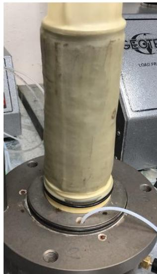
*Figura A. 24: Colocación y posición de los O rings en el pedestal.*
