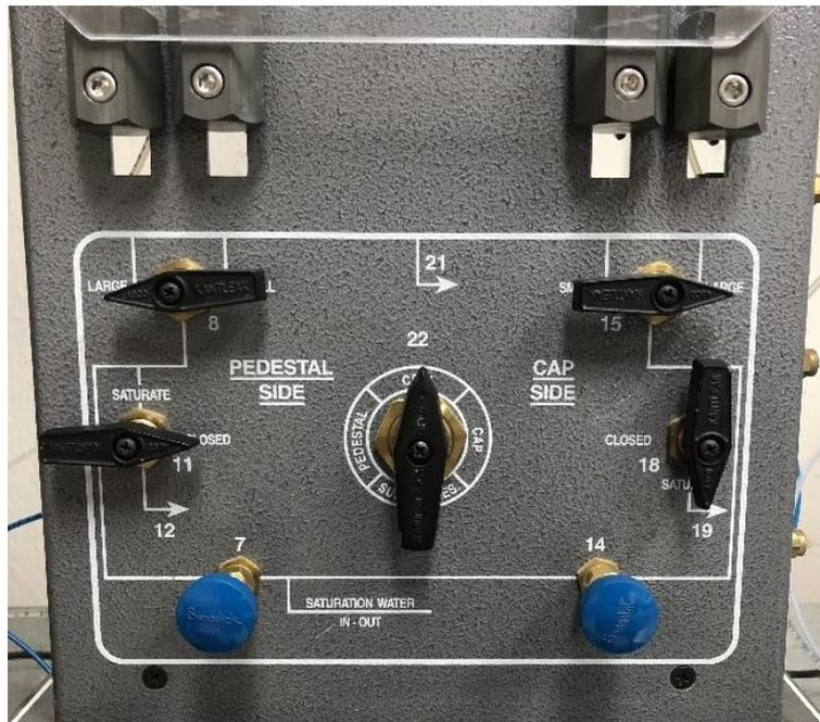
Figura A. 26: Configuración de manecillas de la columna de control superior.
