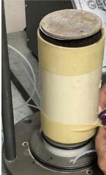
*Figura A. 23: Base de la cámara triaxial con la muestra de suelo y membrana.*
