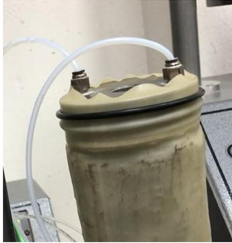
Figura A. 25: Colocación y posición de los O rings en el cap.
