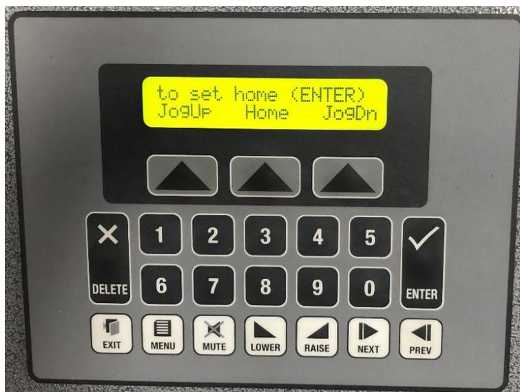
Figura A. 58: Menú para colocar en posición a la celda triaxial.
