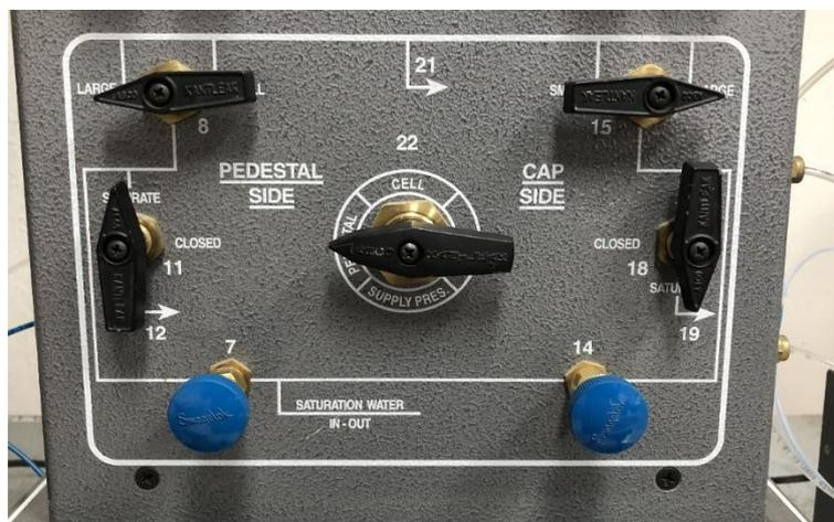
Figura A. 15: Configuración de manecillas de la columna de control superior.
