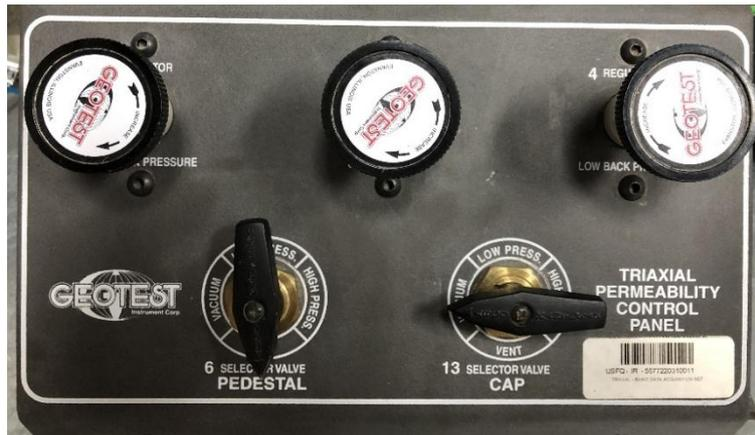
Figura A. 34: Configuración de manecillas de la columna de control inferior para generar vacío en el cap.
