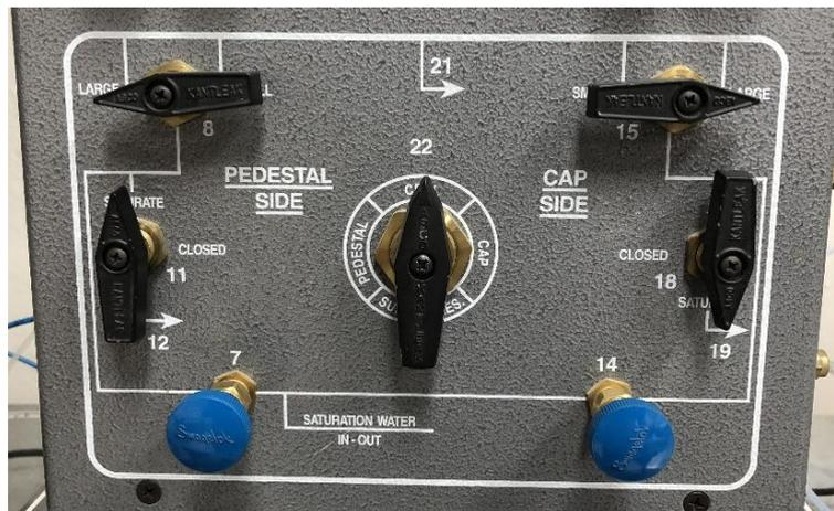
Figura A. 35: Posición de las manecillas superior de la comuna triaxial aplicar la presión y que el agua percole hasta llegar al cap.
