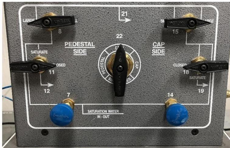
Figura A. 43 Posición de las manecillas de la columna triaxial superior para llenar las buretas.
