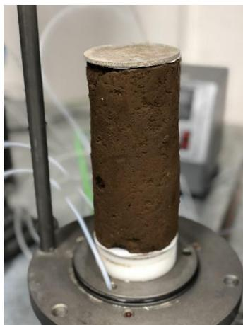
Figura A. 20: Colocación de la muestra de suelo.
