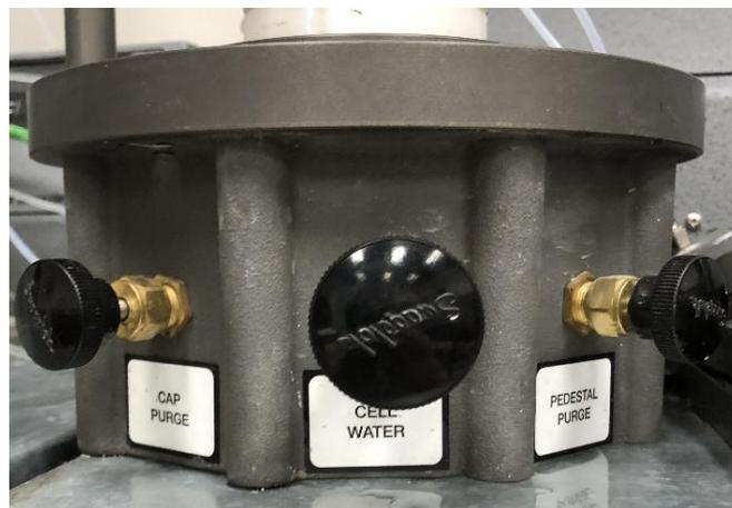
*Figura A. 30: Llave de paso de agua de la celda triaxial (Cell Water).*
