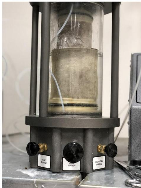
*Figura A. 31 Celda triaxial con llenandose con agua.*
