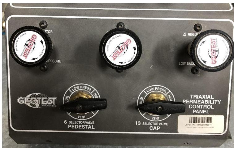
Figura A. 38: Posición de las manecillas de la columna triaxial inferior para llenar las buretas.
