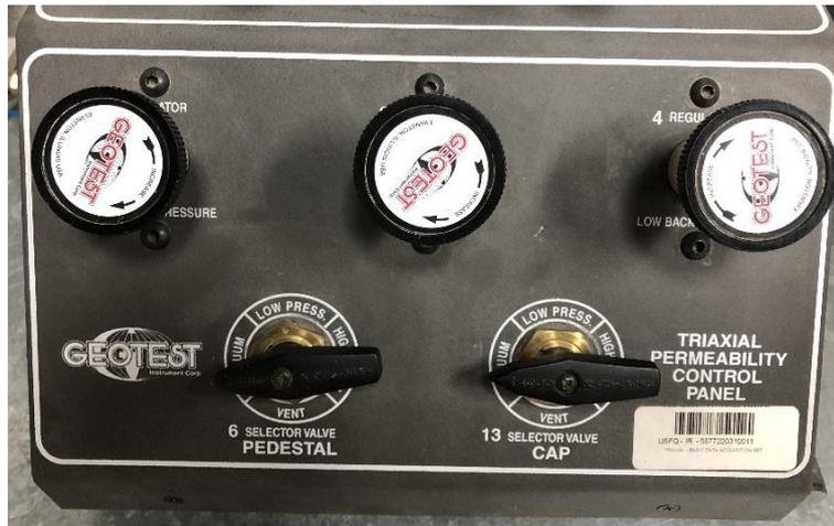
Figura A. 44: Posición de las manecillas de la columna triaxial inferior para llenar las buretas.
