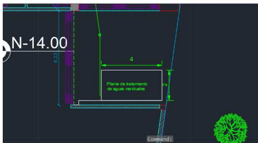
Figura 26: Ubicación propuesta para planta de tratamiento de agua residual en acero
