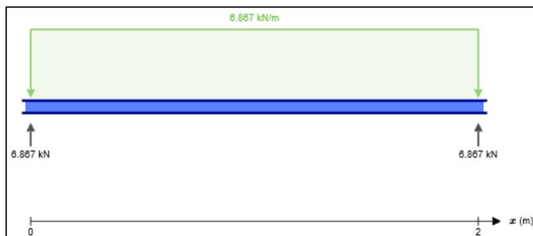
Figura 41: Aplicación de cargas
