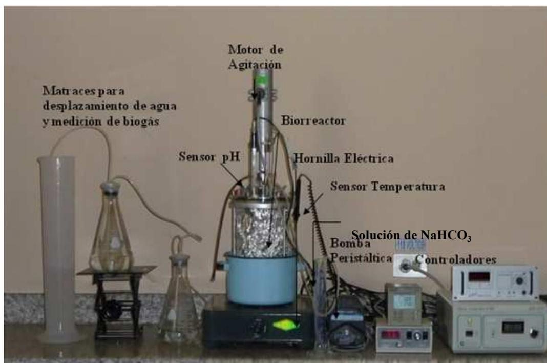
Figura 3.2: Descripción de los diferentes componentes del reactor semi-continuo
