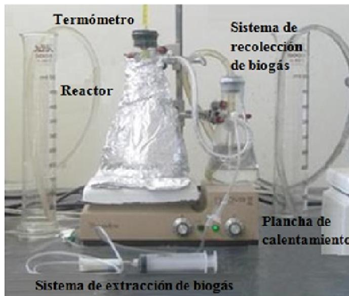
Figura 3.1: Descripción de los diferentes componentes en un reactor discontinuo
