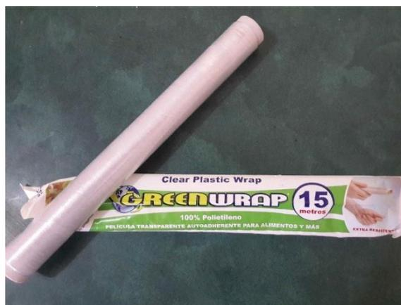
*Figura 4: Muestra del LDPE usado en el experimento*
