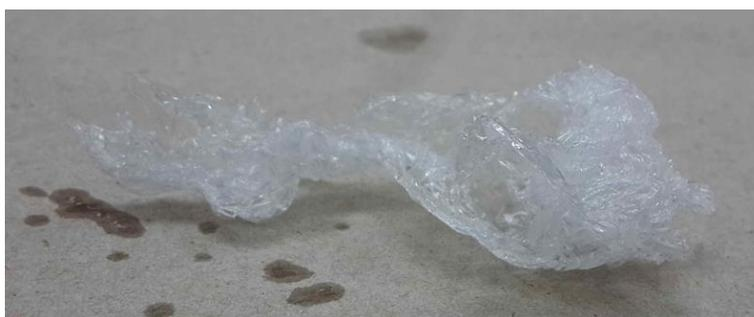
*Figura 15: Muestra de LDPE después del tratamiento de envejecimiento térmico*
